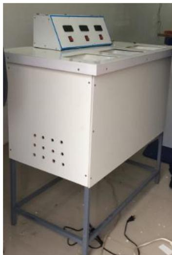
**Figura 40. Máquina de termociclado USFQ.**
