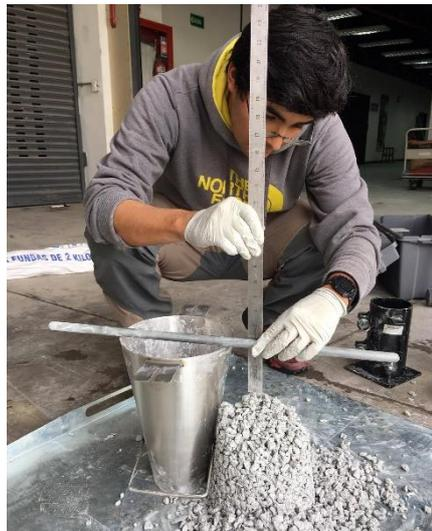
Figura 2.57 Revenimiento de mezcla de prueba con Cemento Portland
