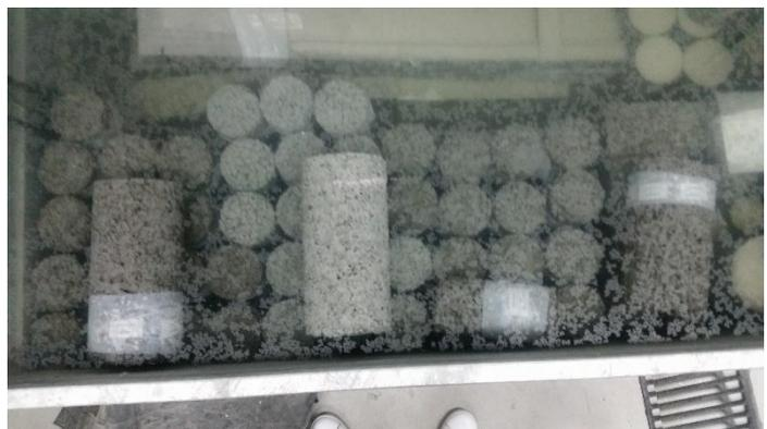
Figura 2.55 Especímenes en Piscina de Curado a 21° C
