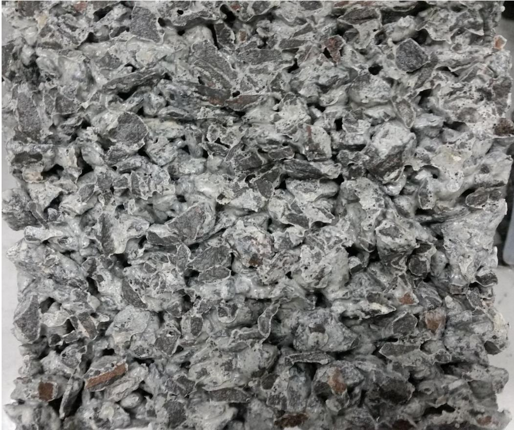
*Figura 3.1 Plano de falla de viga de hormigón permeable con cementoPortland*
