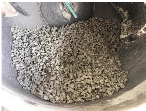
Figura 2.51 Hormigón permeable con cemento Portland en concretera
