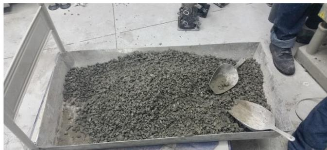
Figura 2.49 Hormigón permeable fresco con cemento Portland
