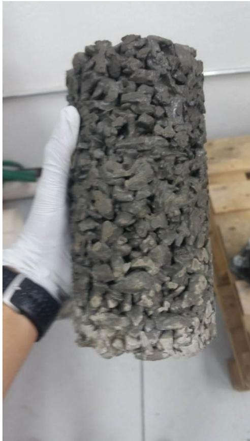
Figura 2.54 Cilindro de concreto permeable con cemento Hidráulico
