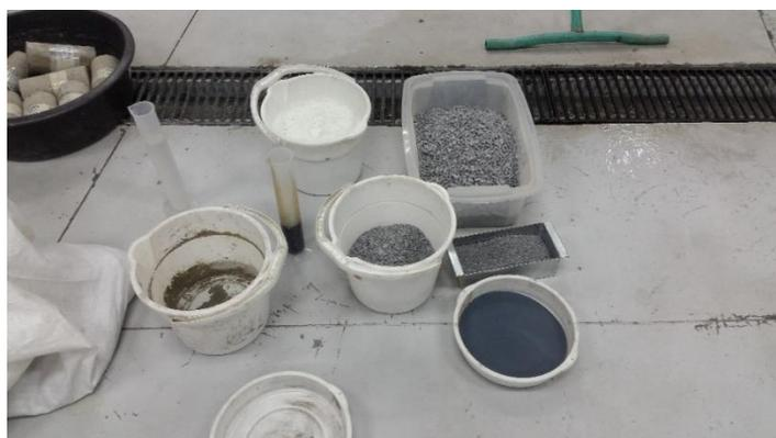
Figura 2.48 MATERIAL UTILIZADO PARA ELABORACIÓN DE VIGUETAS DE HORMIGÓN PERMEABLE UTILIZANDO CEMENTO PORTLAND
