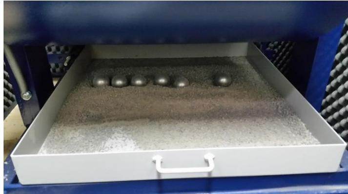
*Figura 2.6 AGREGADO DESPUÉS DE SER SOMETIDO A LA PRUEBA DE ABRASIÓN EN LA MÁQUINA DE LOS ÁNGELES*
