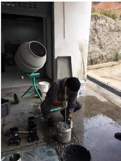
Figura 2.59 Obtención de porcentaje de vacíos de mezclas de prueba
