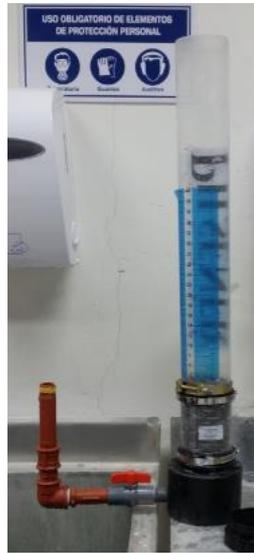
Figura 2.47 Permeómetro utilizado para las obtener la constante de permeabilidad de los cilindros
