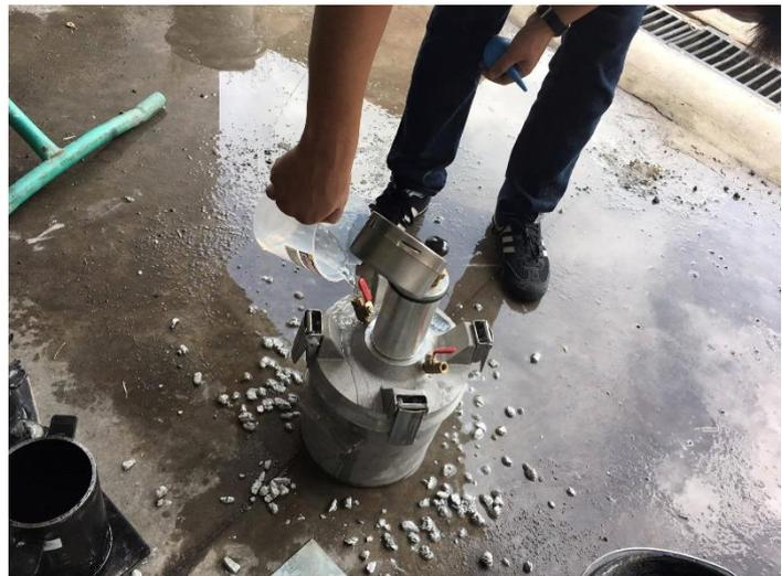
Figura 2.58 Obtención de porcentaje de vacíos por Norma ASTM C231M-14
