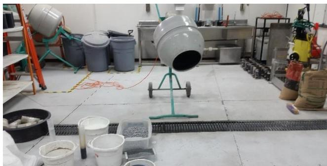
Figura 2.50 Concretera y dosificación para cilindros
