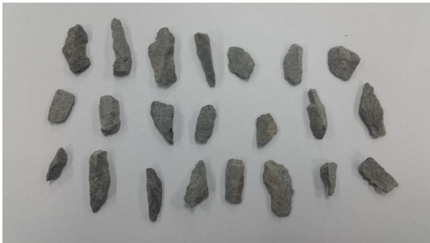
*Figura 3.3 Agregado 3/8" con forma laminar*
