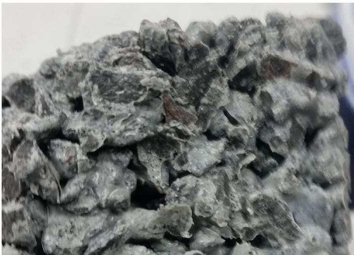
*Figura 3.2 Falla de cilindro por rotura de agregado grueso*
