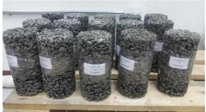
Figura 2.56 Cilindros etiquetados de concreto permeable con cemento Pozolánico tipo IP
