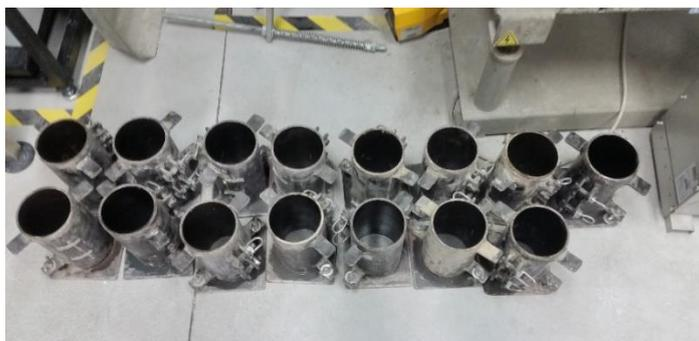
Figura 2.52 Encofrados cilíndricos de 4"\*8"
