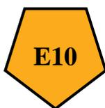
Los tanques que contienen combustible con etanol deben ser etiquetados. Generalmente se utiliza una calcomanía con un pentágono en color bronce con el porcentaje de aditivación marcado en negro (U.S. Department of Energy et al, 2005: 15).
