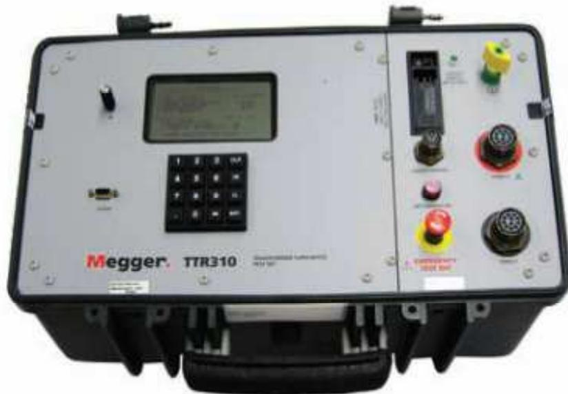
Figura 27 Gráfico del equipo de medición de relación de transformación de transformadores TTR 310 (Megger)
