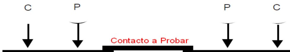
Figura 34 Gráfico de la conexión para las pruebas de resistencia en un conductor (Megger)
