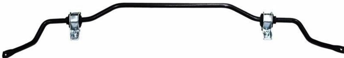
Fig. 1.10 Barra Estabilizadora (Lima, 2017)
