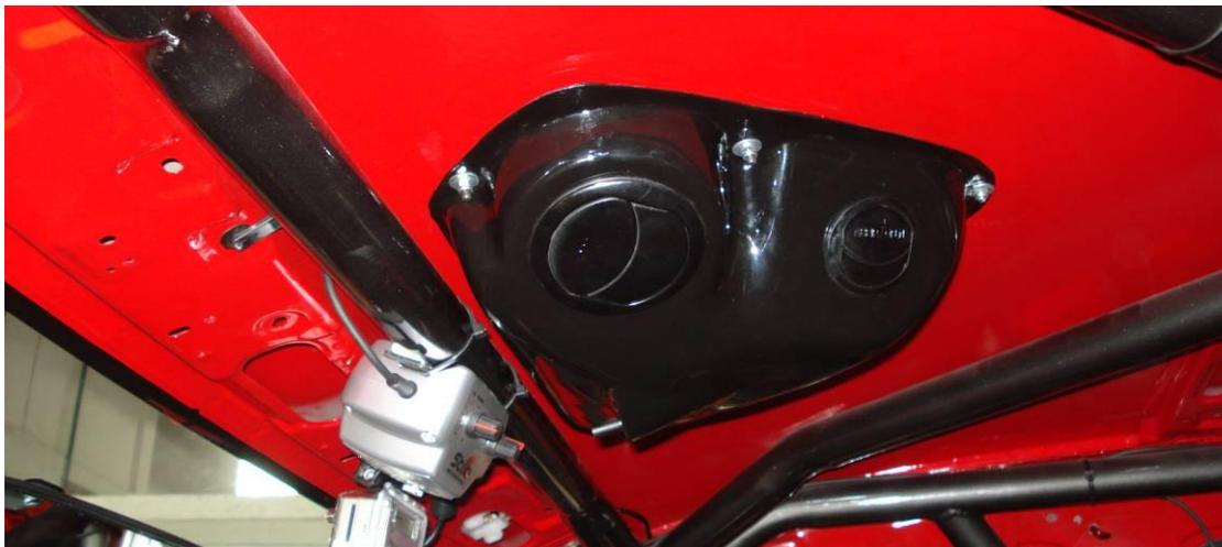
Fig. 1.38 Toma de Aire Cabina (exterior) (Banderas, 2011)
