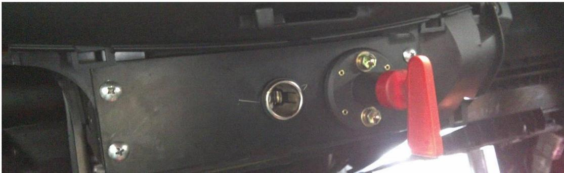
Fig. 1.42 Cortador de Corriente (Banderas, 2011)
