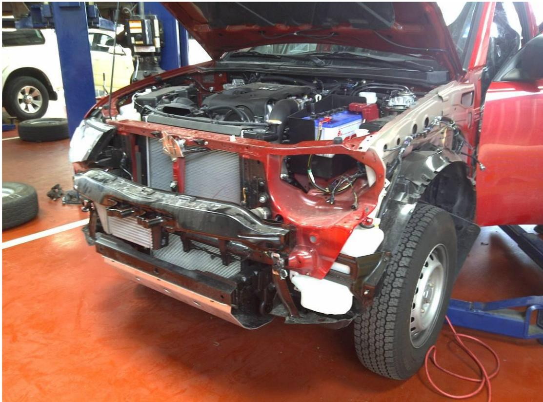
Fig. 1.35 Desmontaje de guarda choque e instalación de refuerzos (Banderas, 2011)
