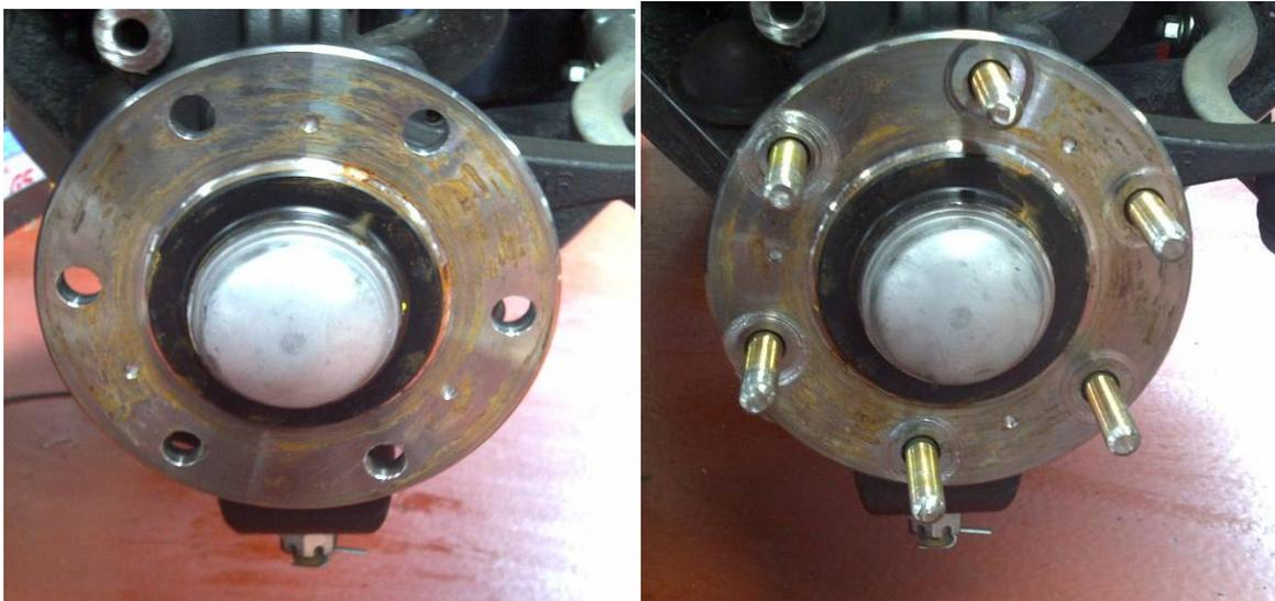
Fig. 1.39 Montaje & Desmontaje de Espárragos (Banderas, 2011)
