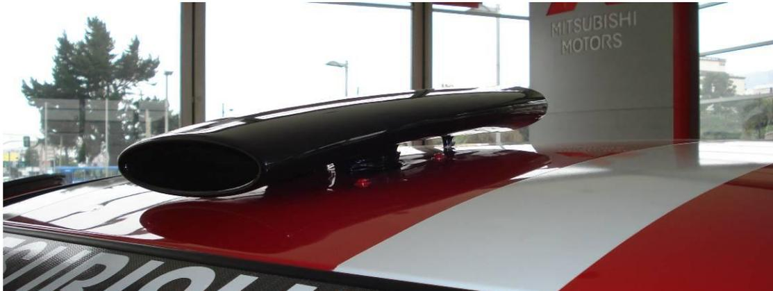
Fig. 1.37 Toma de Aire Cabina (exterior) (Banderas, 2011)
