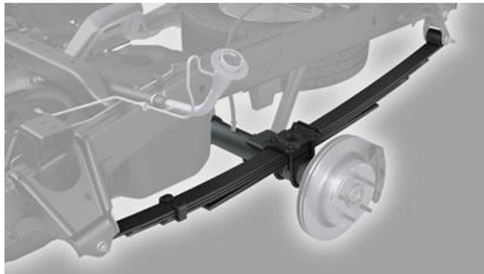
Fig. 1.8 Ballestas de Suspensión (Aficionados a la Mecánica, 2014)
