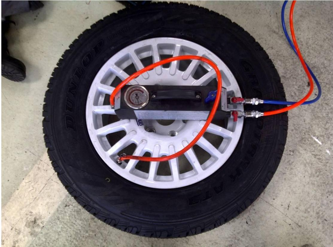
Fig. 1.34 Aro BRAID & Llanta Dunlop AT3 inflado con Nitrógeno (Banderas, 2011)
