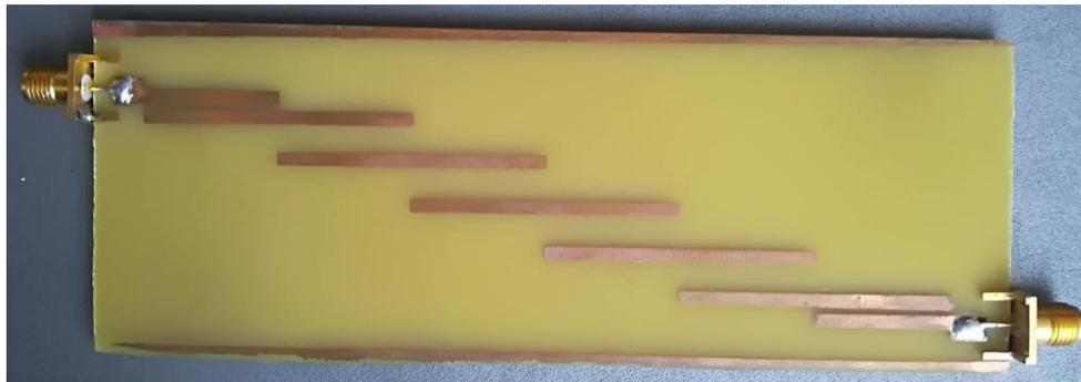
Figura 39. Filtro Pasa Banda con líneas acopladas
