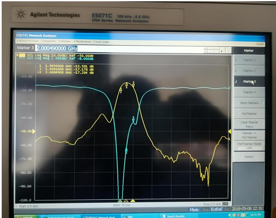
Figura 40. Medición del filtro pasa banda con líneas acopladas en el analizador de redes
