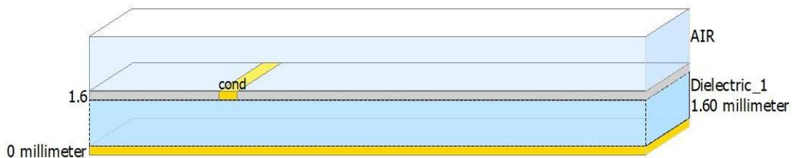
Figura 33. Creación del sustrato dentro del módulo Momentum en ADS
