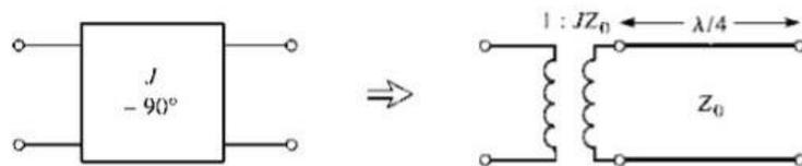
Figura 16. Circuito equivalente de los inversores de admitancia de secciones finales. (Pozar, 2012)
