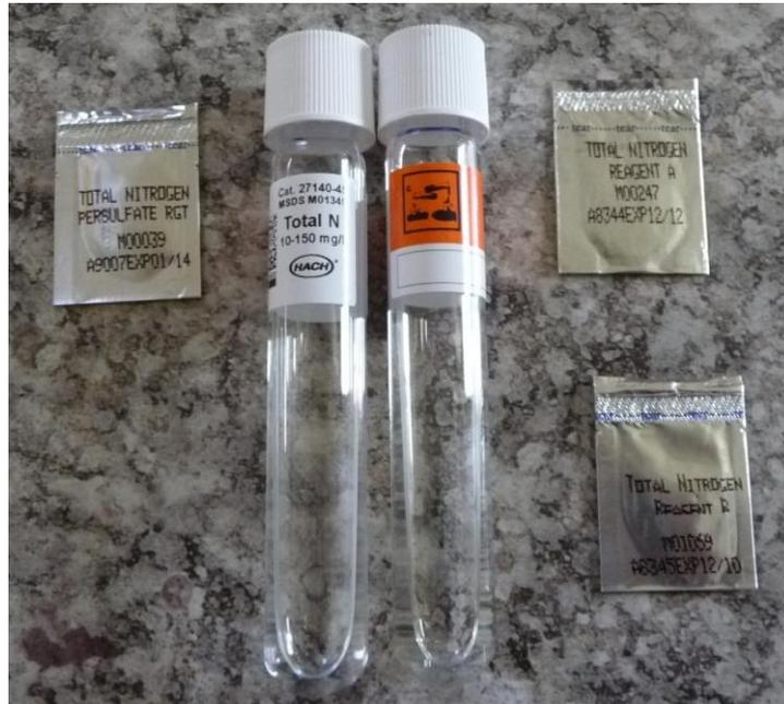
Figura 3.5: Viales y sobres para determinación de nitrógeno total
