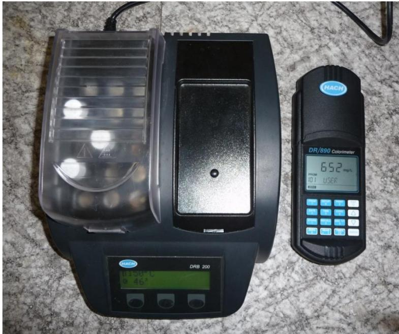
Figura 3.4: Reactor y Colorímetro HACH
