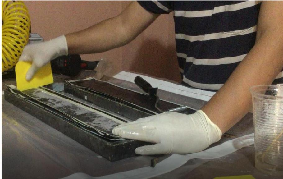
**Figura 35.** Laminado sobre los moldes.
