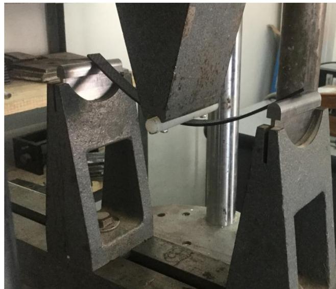
**Figura 27.** Montaje del espécimen para ensayo de flexión a 3 puntos.
