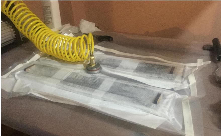
**Figura 37.** Vacío interno de las piezas.
