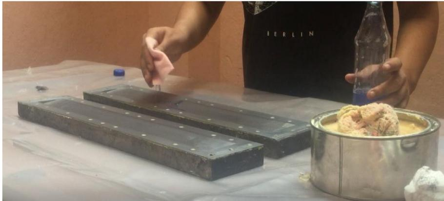
**Figura 32.** Aplicación del desmoldante.
