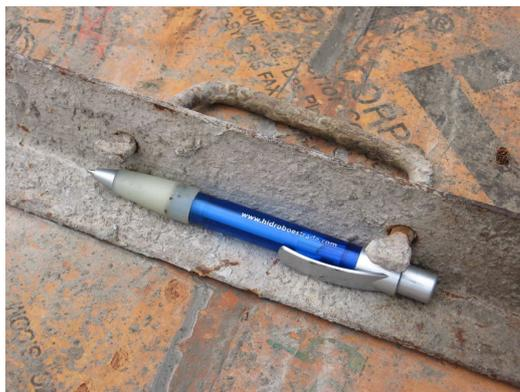
Foto 2.2.- Manija en un tablero de encofrado de la empresa INTACO S.A.
