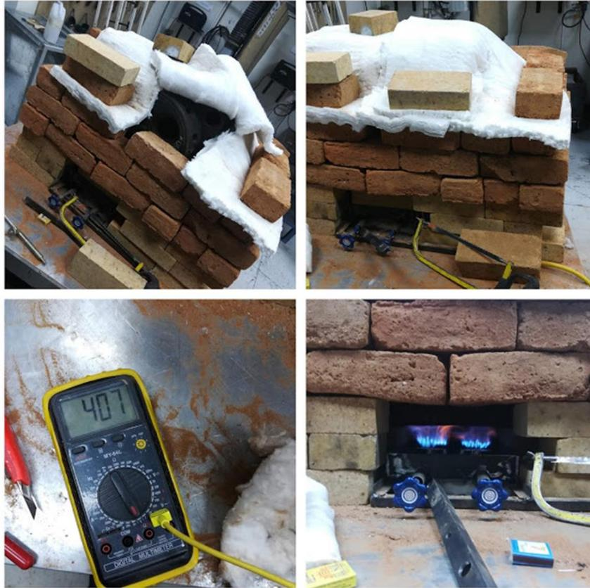
**Figura 21.** Sistema de Pre calentamiento para el Cabezote Wärtsilä
