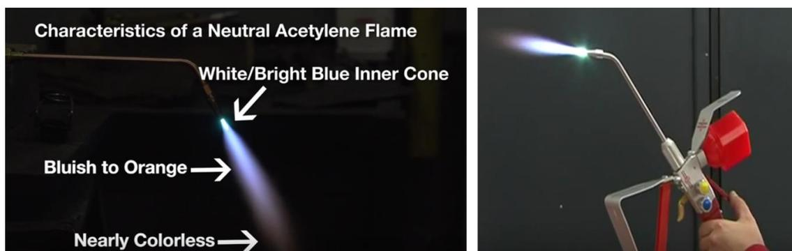
**Figura 23.** Configuración correcta del equipo de metalización. Eutalloy Super Jet-S
