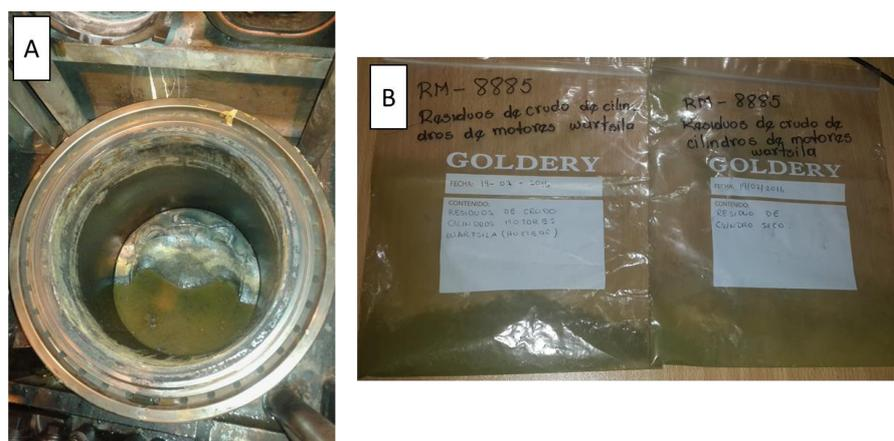
**Figura 15.** Residuos de la combustión A) Toma de muestras en campo. B) Almacenamiento de las muestras
