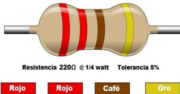
*Ilustración 37 Resistencia 220 ohms @ ¼ W*
