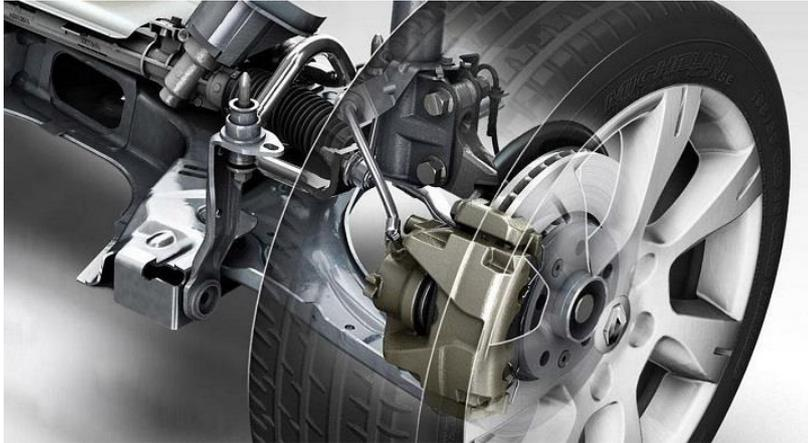
*Ilustración 22 Sistema de frenos*
