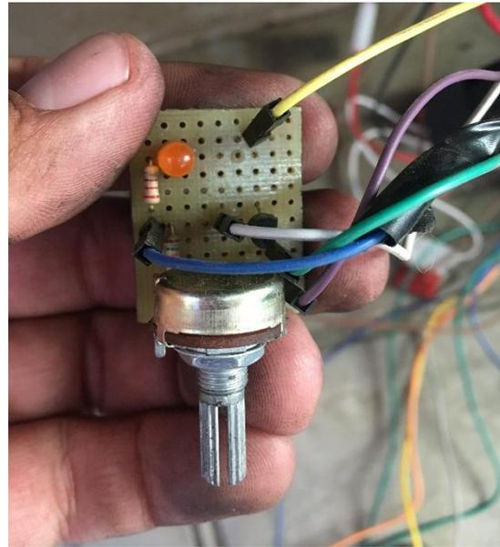
*Ilustración 31 Circuito sensor de luces*
