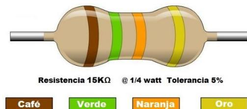
*Ilustración 38 Resistencia 15 K ohms @ ¼ W*
