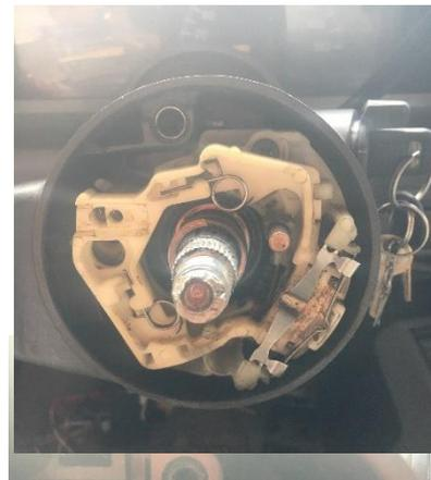
*Ilustración 46 Desarmado del volante*
