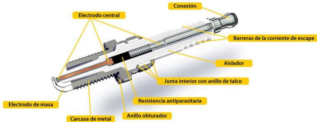
*Ilustración 3 Partes de la bujía*
