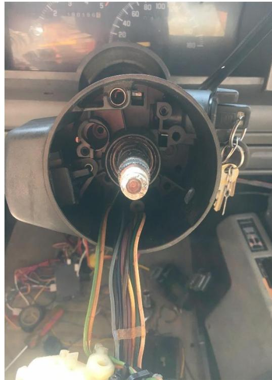
*Ilustración 51 Cables del switch*
