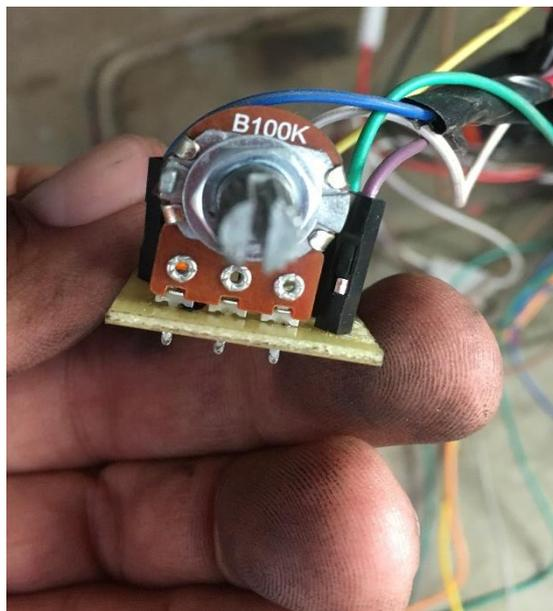
*Ilustración 33 Potenciómetro*
