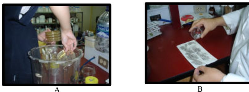
Figura 21. Colocación de placas Petri en anaerobiosis (A); colocación de agua destilada al Anaerocult A para su activación (B)
