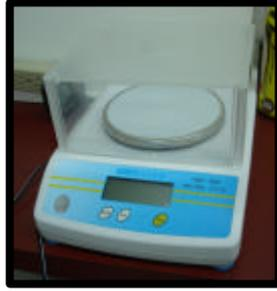
Figura 7. Balanza de precisión usada en la metodología.
