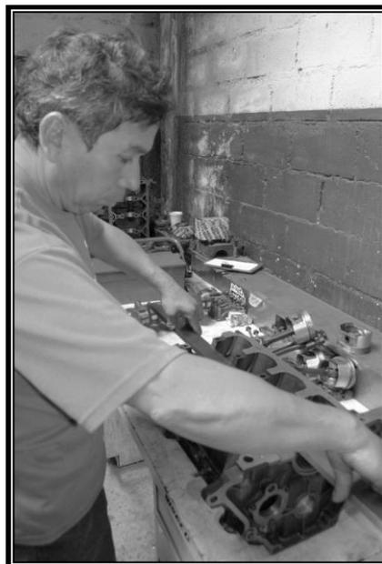
*Fotografía #. 42 Medición del túnel de bancada del bloque motor. (Autor, 2009)*
