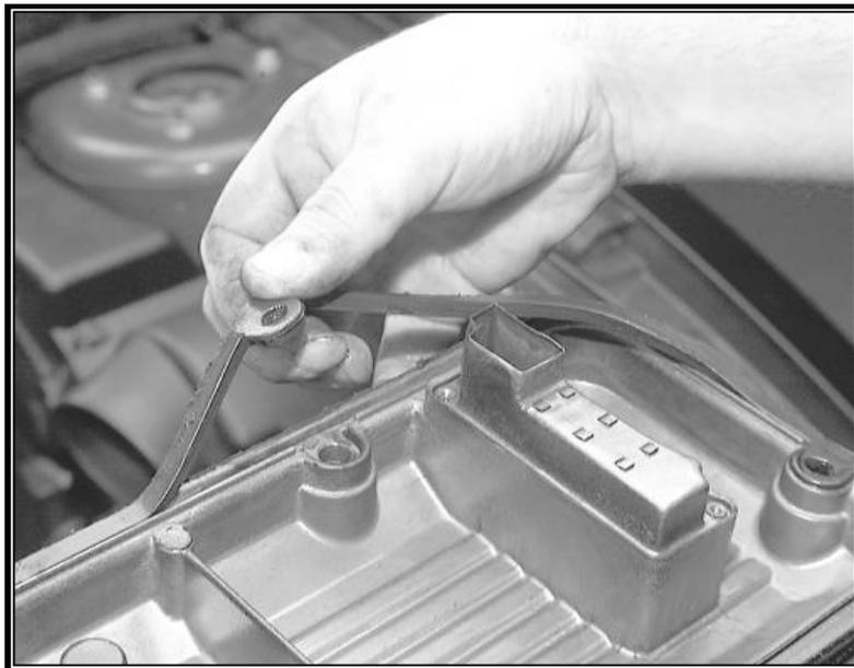
*Ilustración #. 81 Junta de la tapa de válvulas. (AutoZone, 2018)*
