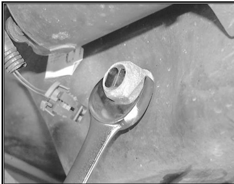
*Ilustración #. 105 Sensor de nivel de aceite, (AutoZone, 2018)*
