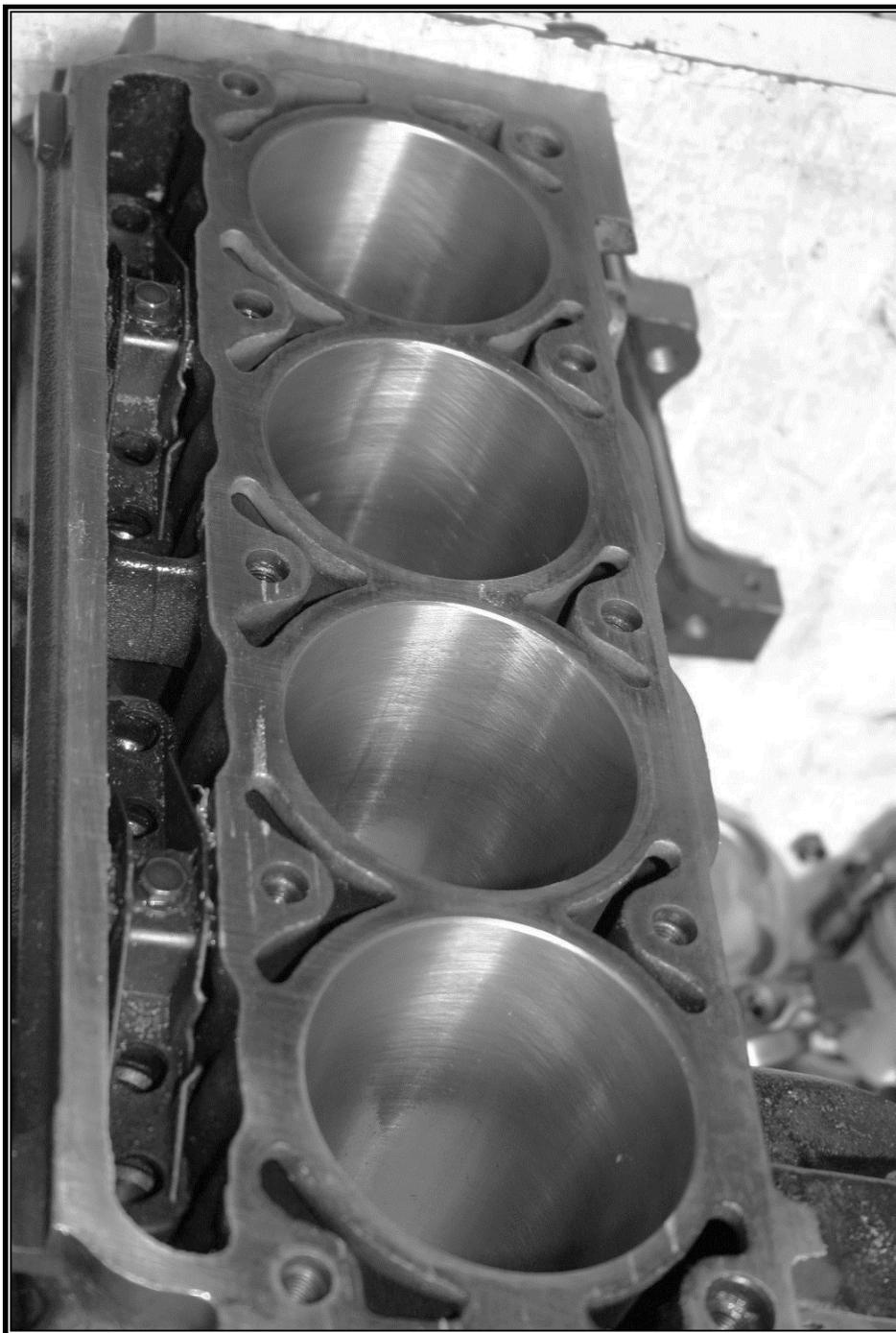
*Fotografía #. 53 Cilindros de bloque motor pulidos. (Autor, 2009)*
