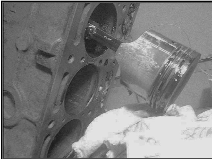
*Ilustración #. 120 Extracción pistón. (The Oil Crash, 2014)*
