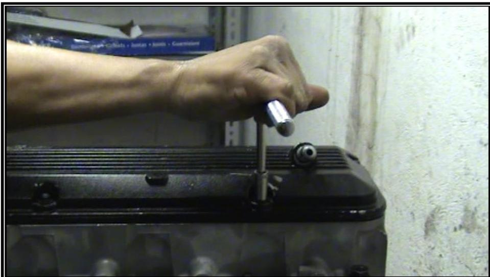
*Fotografía #. 91 Instalación tapa de válvulas. (Autor, 2009)*
