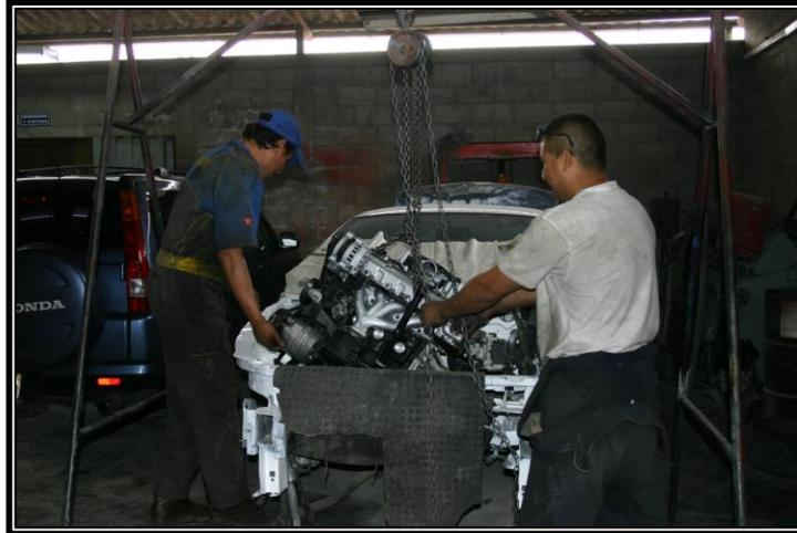
Fotografía #. 94 Montaje de motor. (Autor, 2009)
