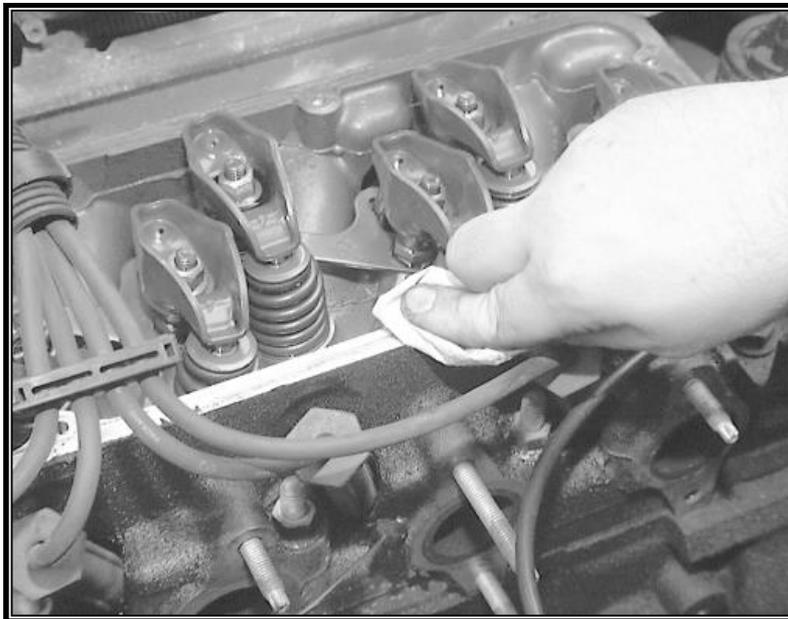
*Ilustración #. 83 Limpieza parte superior del cabezote. (AutoZone, 2018)*
