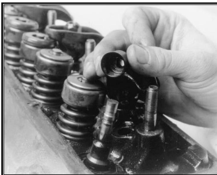
*Ilustración #. 97. Sello tipo paraguas de válvula. (AutoZone, 2018)*
