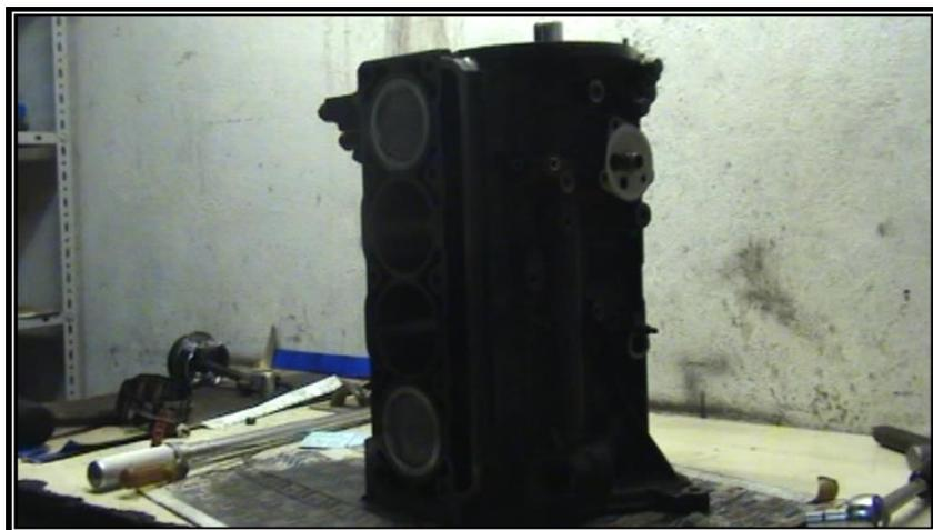
*Fotografía #. 63 Bloque motor instalado los pistones uno y cuatro. (Autor, 2009)*
