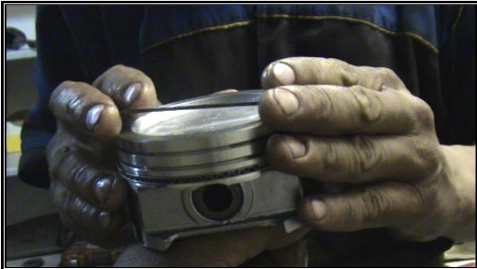
*Fotografía #. 71 Instalación de rines en el cilindro. (Autor, 2009)*
