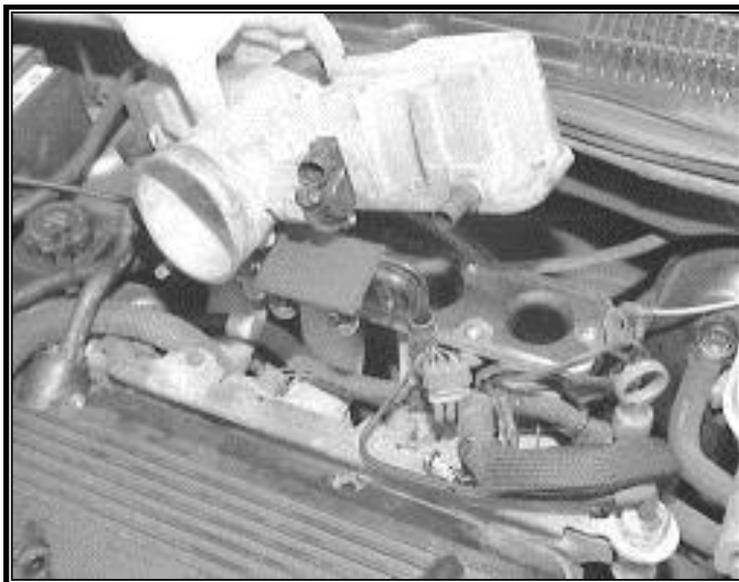
*Ilustración #. 62 Colector de admisión. (AutoZone, 2018)*
