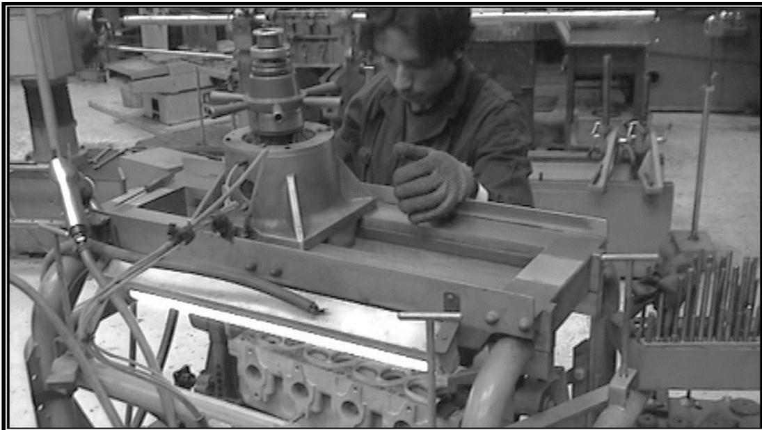
*Fotografía #. 26 Rectificando el asiento de válvulas. (Autor, 2009)*
