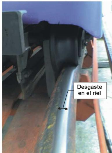
**Ilustración 30. Desgaste causado en el riel por la rueda.**
