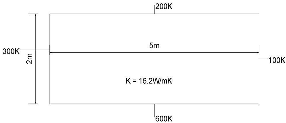
Figura 4.16: Dimensiones y condiciones ejemplo 7.
