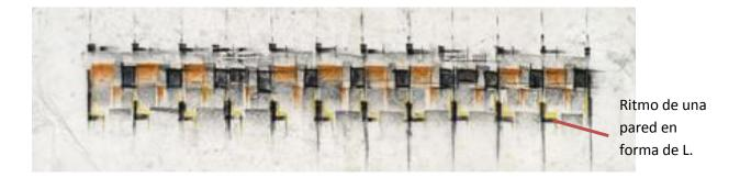
La planta del edificio se basa en la idea de una serie de elementos corpóreos (muros portantes, núcleos sanitarios compactos, módulos de madera independientes) situados a intervalos regulares a lo largo de la planta baja y rodeada de un espacio continuo.
