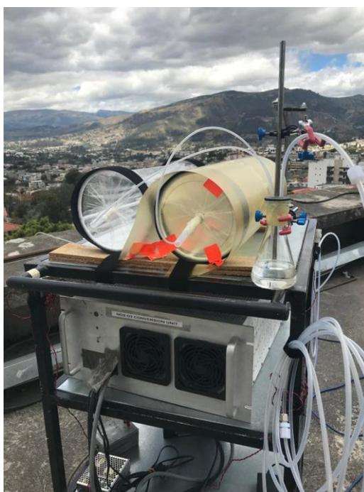
*Figura 11. Aplicación de acetona como perturbación en el sistema.*
