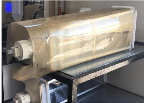
*Figura 5. Cámara ambiental de sistema MOPS cubierta con lámina Ultem.*
