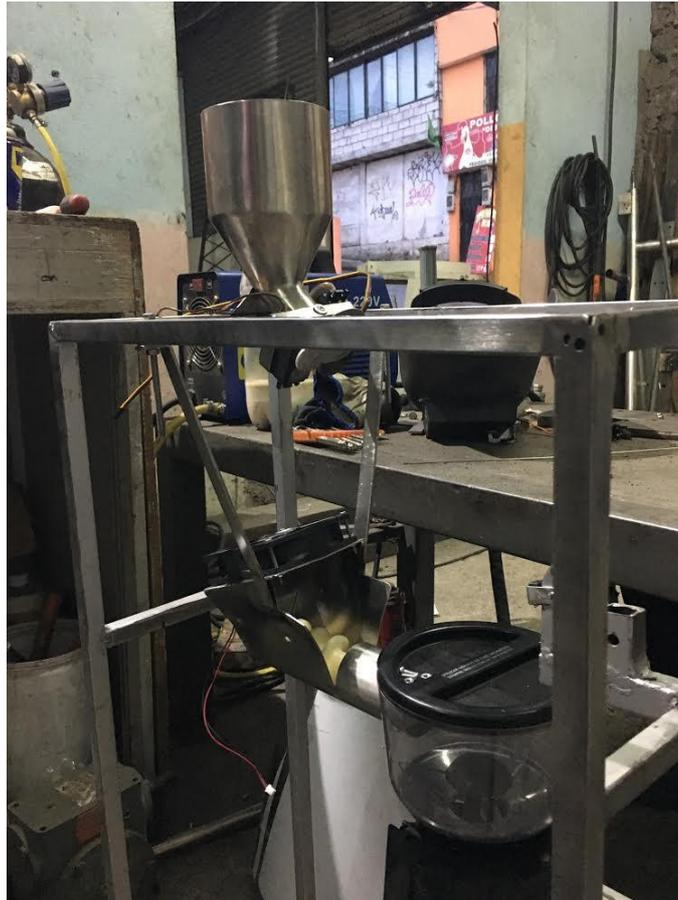
Figura 1-43 Soporte del frasco de almacenamiento incorporada en el bastidor.
