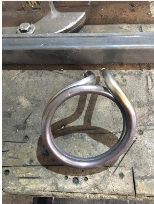
Figura 1-30 Elemento calentador. (Proceso de Tostado)
