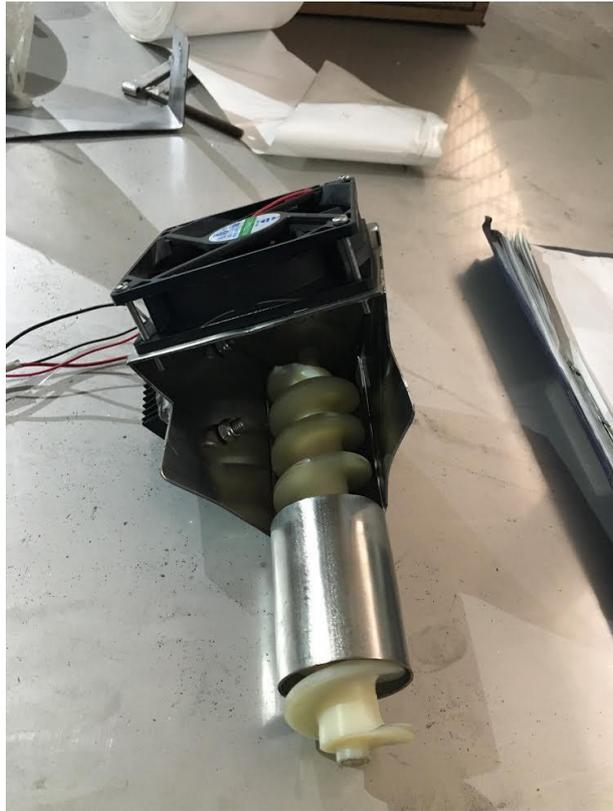
Figura 1-37 Sistema de enfriamiento terminado.
