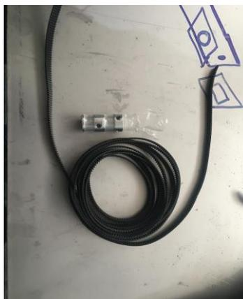
Figura 1-48 Correa y dientes para los motores NEMA 17.
