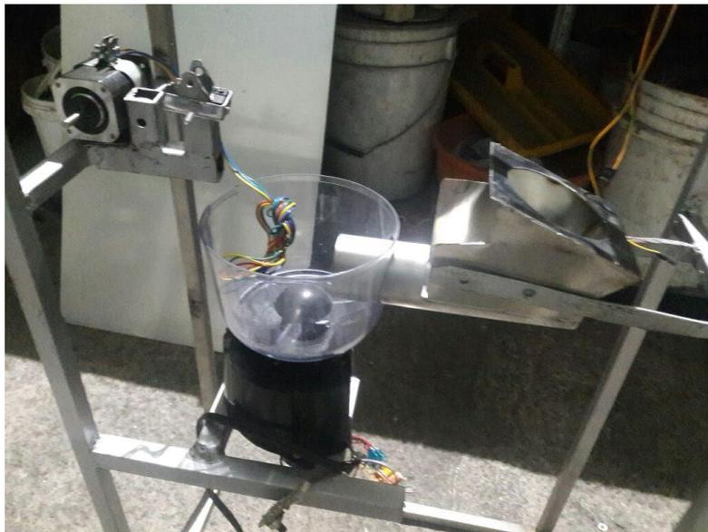
Figura 1-38 Sistema de triturado incorporado al sistema de enfriamiento.
