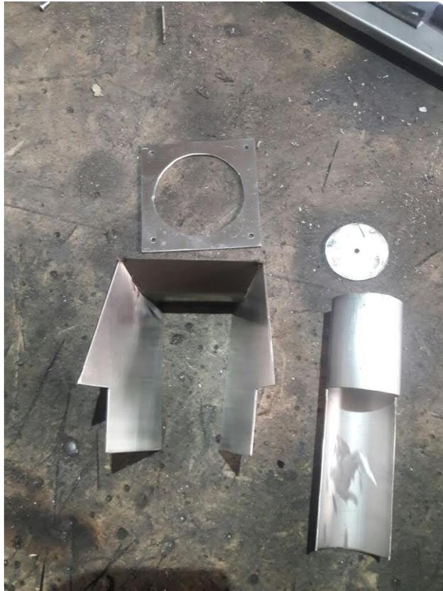
Figura 1-33 Base de ventilador y soporte de Tornillo Sin fin.
