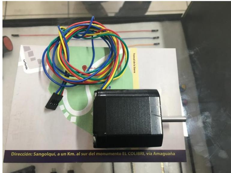
Figura 1-40 Motor eléctrico NEMA 17
