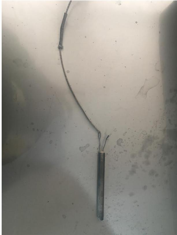
Figura 1-47 Elemento calentador para el proceso de sellado.
