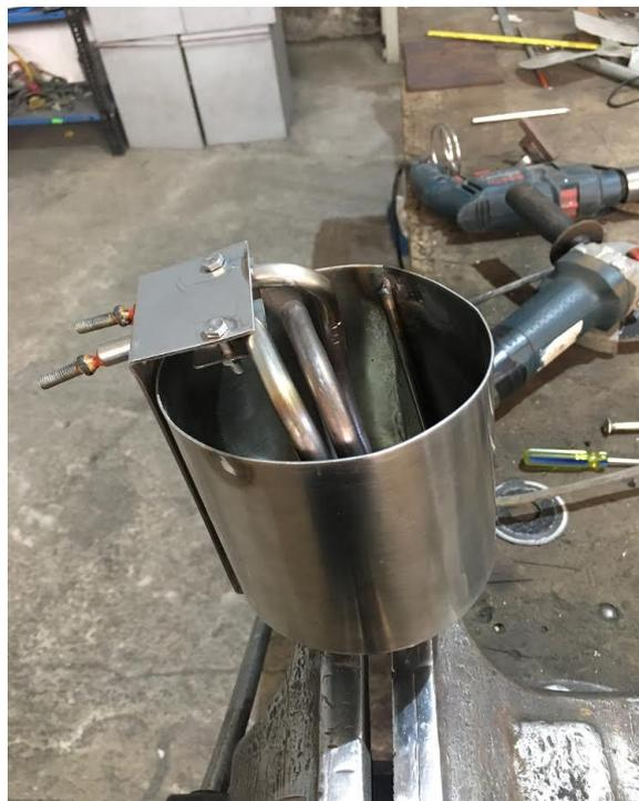
Figura 1-32 Tambor Tostador incorporado el elemento calentador.
