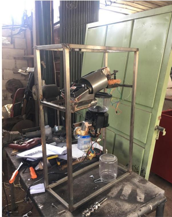
Figura 1-39 Mecanismo de tostado adaptado al sistema de enfriamiento.
