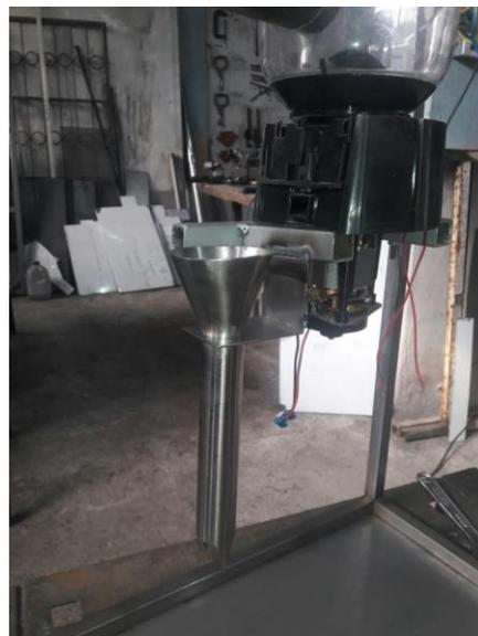
Figura 1-45 Cuello formador adaptado al triturador.
