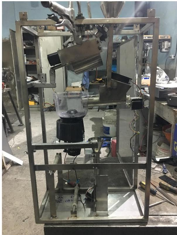
Figura 1-49 Vista lateral (Procesos de Tostado, Enfriado y Triturado)
