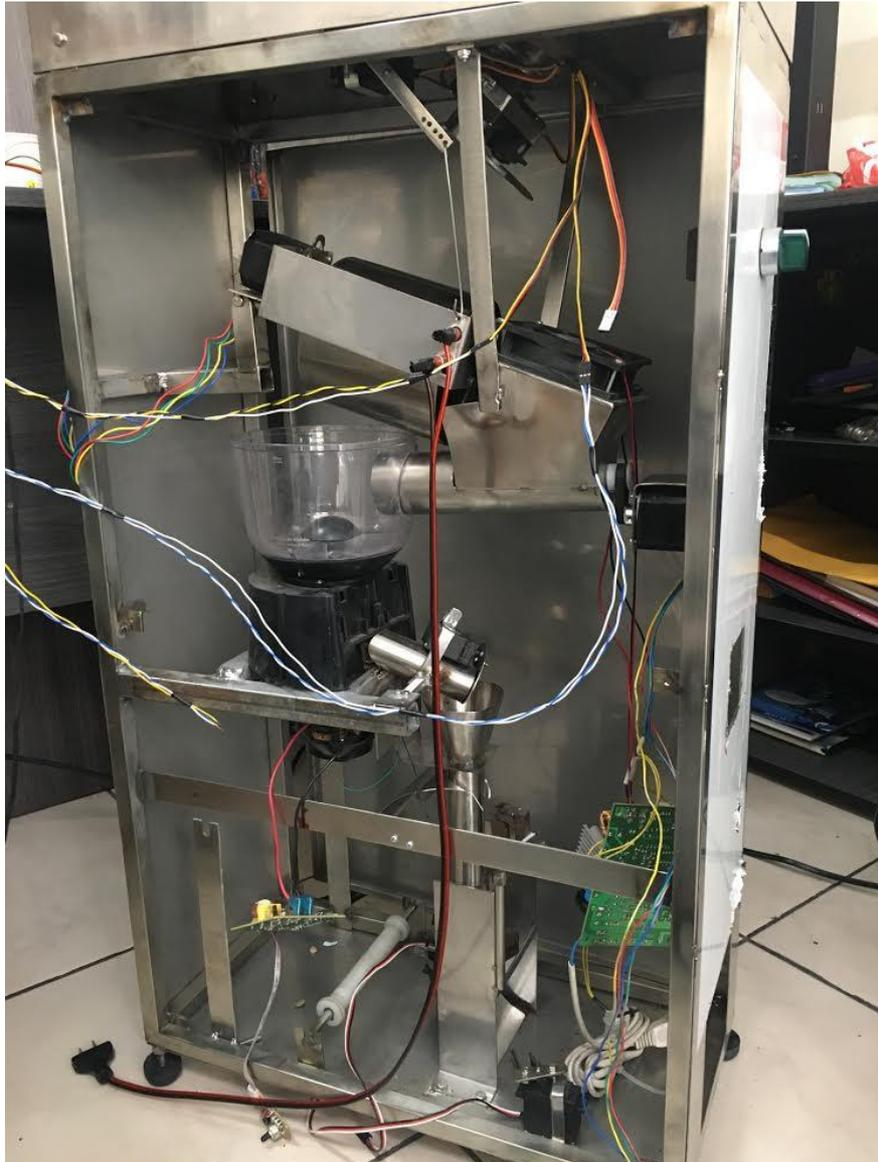
Figura 1-50 Cableado inicial para los motores y servos.
