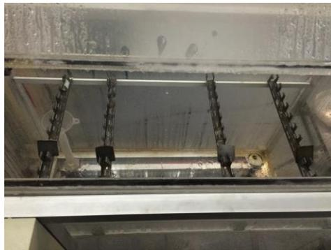
**Figura 13: Probetas montadas en la cámara salina**
