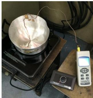
**Figura 11: Montaje para desarrollar las pruebas térmicas a la olla con el recubrimiento.**
