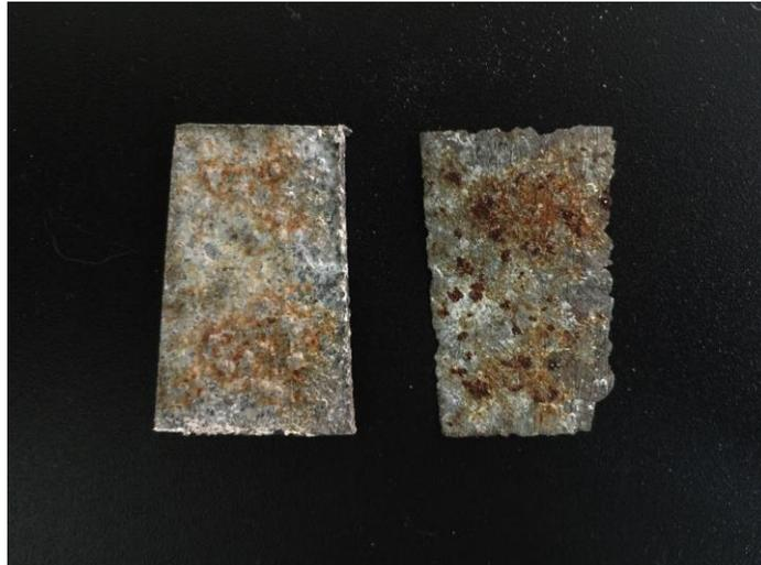
**Figura 28:** Acumulación de sal debido a filtración presente en la interface entre el material base aluminio (izquierda) y en el recubrimiento de acero (derecha)
