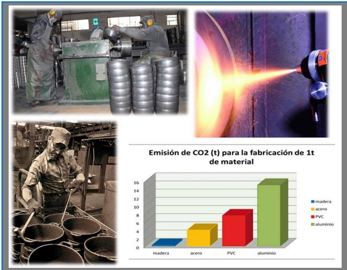
**Figura 1: Fabricación de ollas por método de repujado vs método de termorociado**
