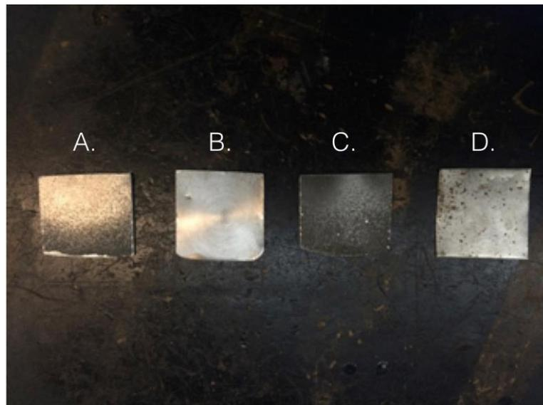
Figura 14: (A)Probeta rugosa 1. (B)Probeta lisa. (C)Probeta rugosa 2. (D)Probeta acero bajo carbono
