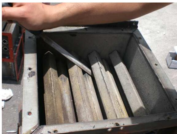
**Figura 6.6** Limpieza de los tubos de la zona de convección.
