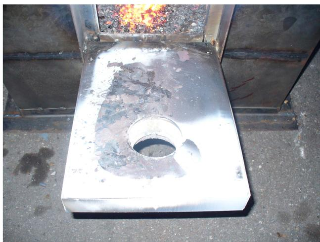
**Figura 6.4 Corrosión originada la puerta del quemador**
