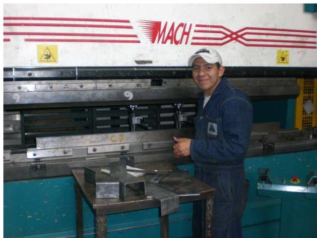
**Figura 4.19** Operario ocupando la plegadora de control automático.
