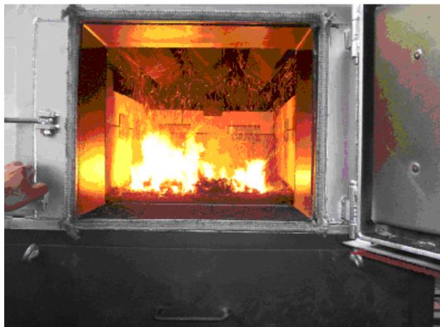
**Figura 2.6 Quemador en funcionamiento del generador de aire caliente Siscafrin**
