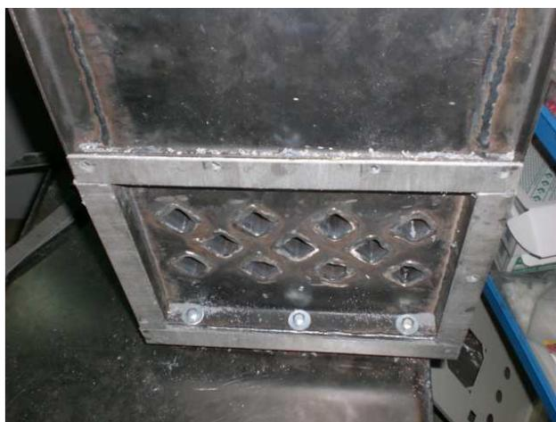
**Figura 4.14 Empaques de amianto puestos en las zonas de convección.**
