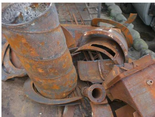
**Figura3.1 Corrosión de las partes del generador de aire caliente de la fábrica de guantes Céleri**
