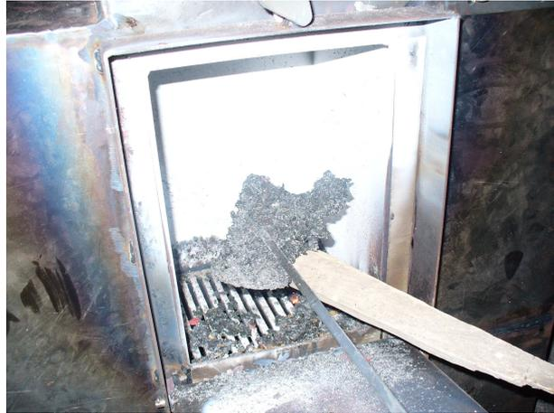
**Figura 6.5** Procedimiento para retirar los residuos de la parte superior de la parrilla.
