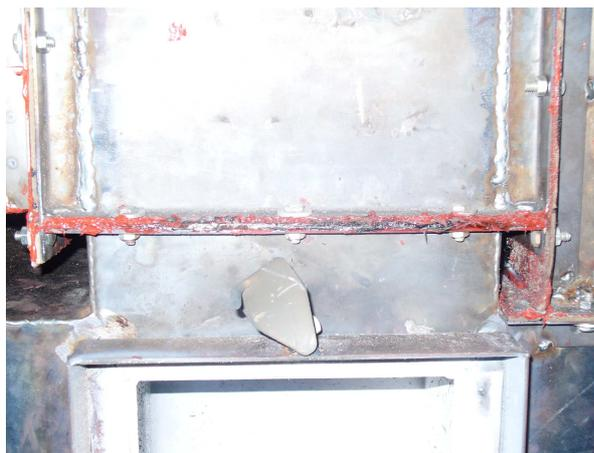
**Figura 6.3 Silicón quemado por la llama que sale por el visor de la puerta.**
