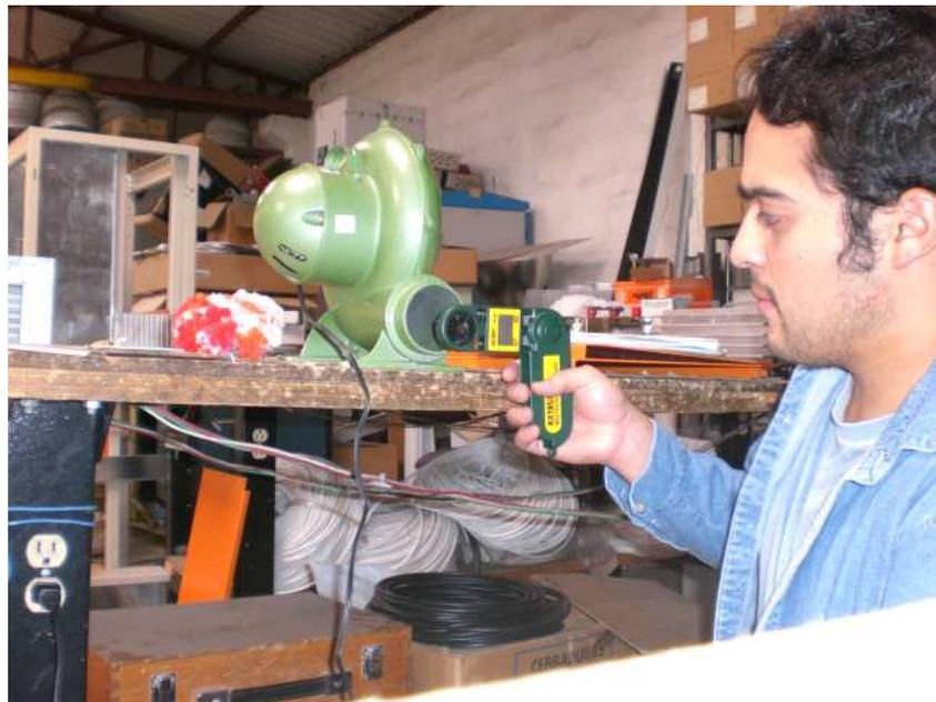
**Figura3.2 Determinación con un anemómetro la velocidad de salida del soplador**
