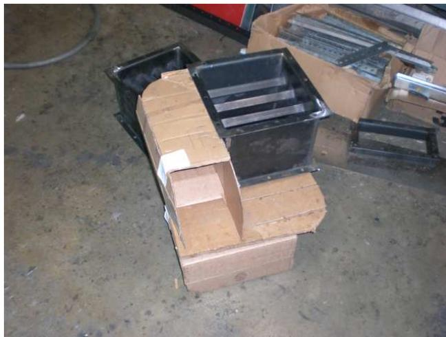
**Figura 4.21 Ductos de cartón elaborado previa a la construcción en metal**
