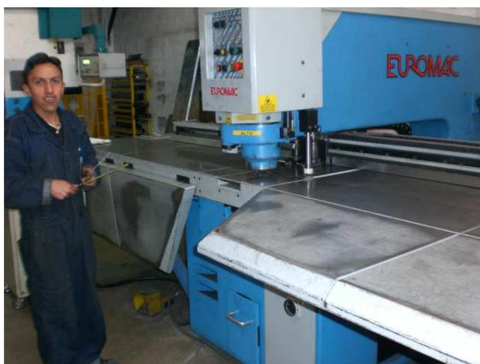
**Figura 4.17 Operario utilizando máquina punzonadora con control numérico.**
