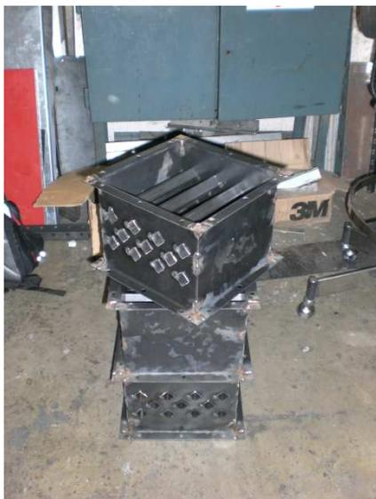
Figura 4.10 Intercambiadores de calor del sector de convección.
