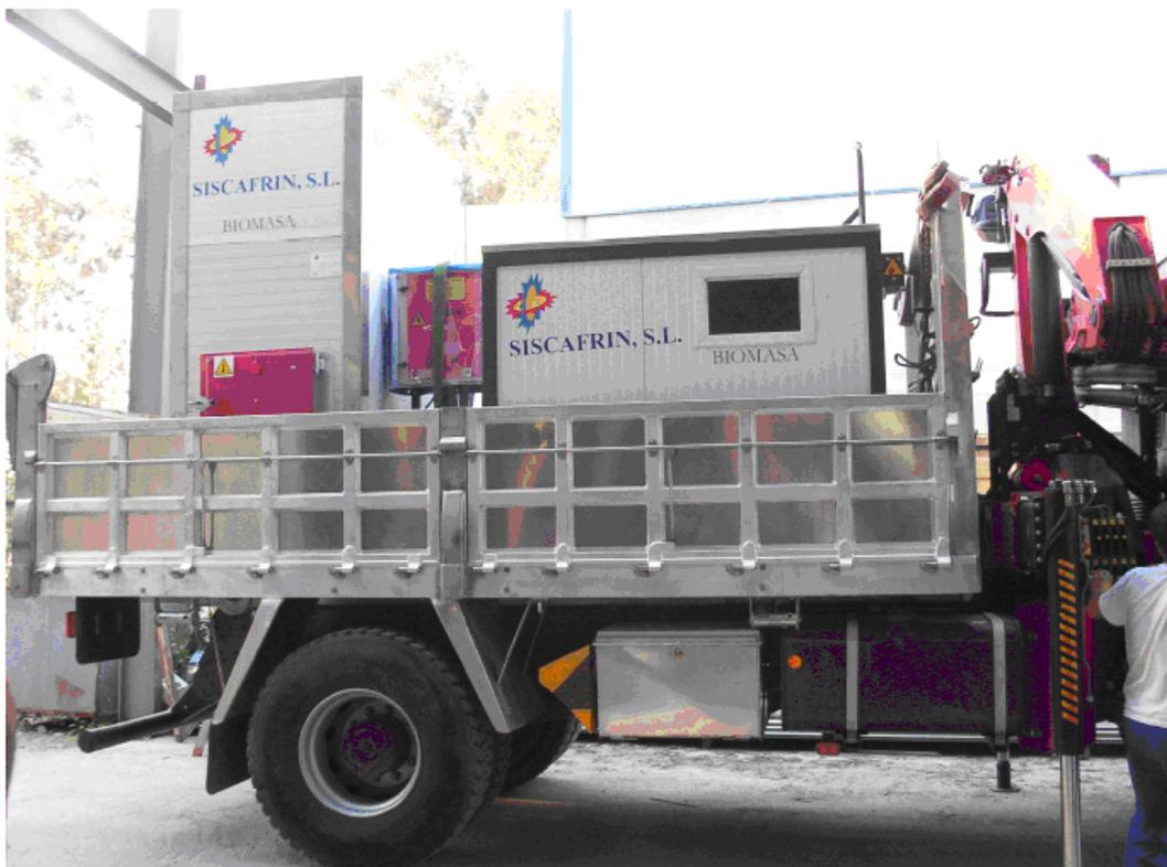
**Figura 2.3 Generador de aire caliente móvil Siscafrin con silo de combustible y cuarto de control incorporado.**
