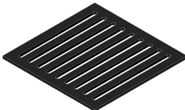
**Figura 4.5 Isometría de la parrilla del generador de aire caliente**
