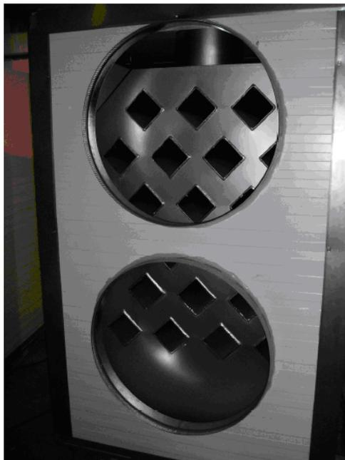
**Figura 2.4 Intercambiador de calor del generador de aire caliente Siscafrin**
