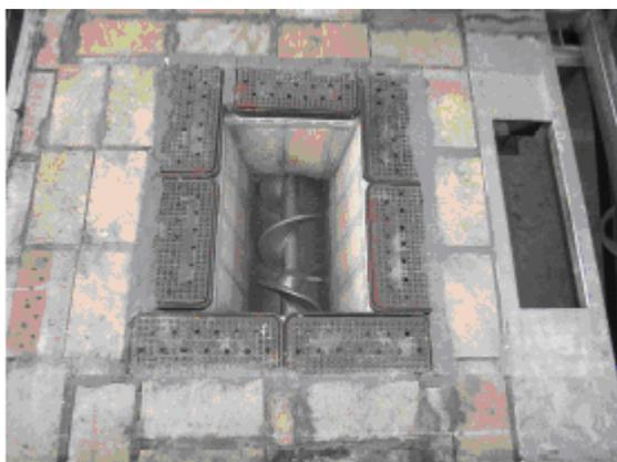
**Figura 2.7 Base del quemador del generador de aire caliente Siscafrin**
