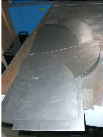
**Figura 4.18** Partes de los ductos punzonadas.
