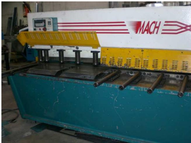
**Figura 4.16 Guillotina hidráulica con control numérico.**
