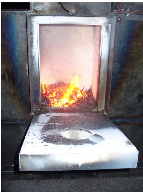
Figura 6.1 Quemador del generador de aire caliente en operación.
