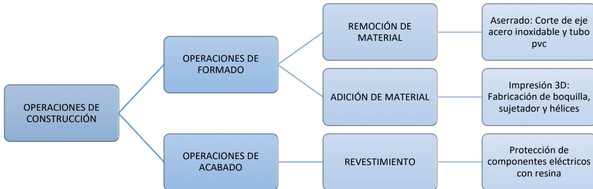
Figura 16. Esquema de operaciones de construcción
