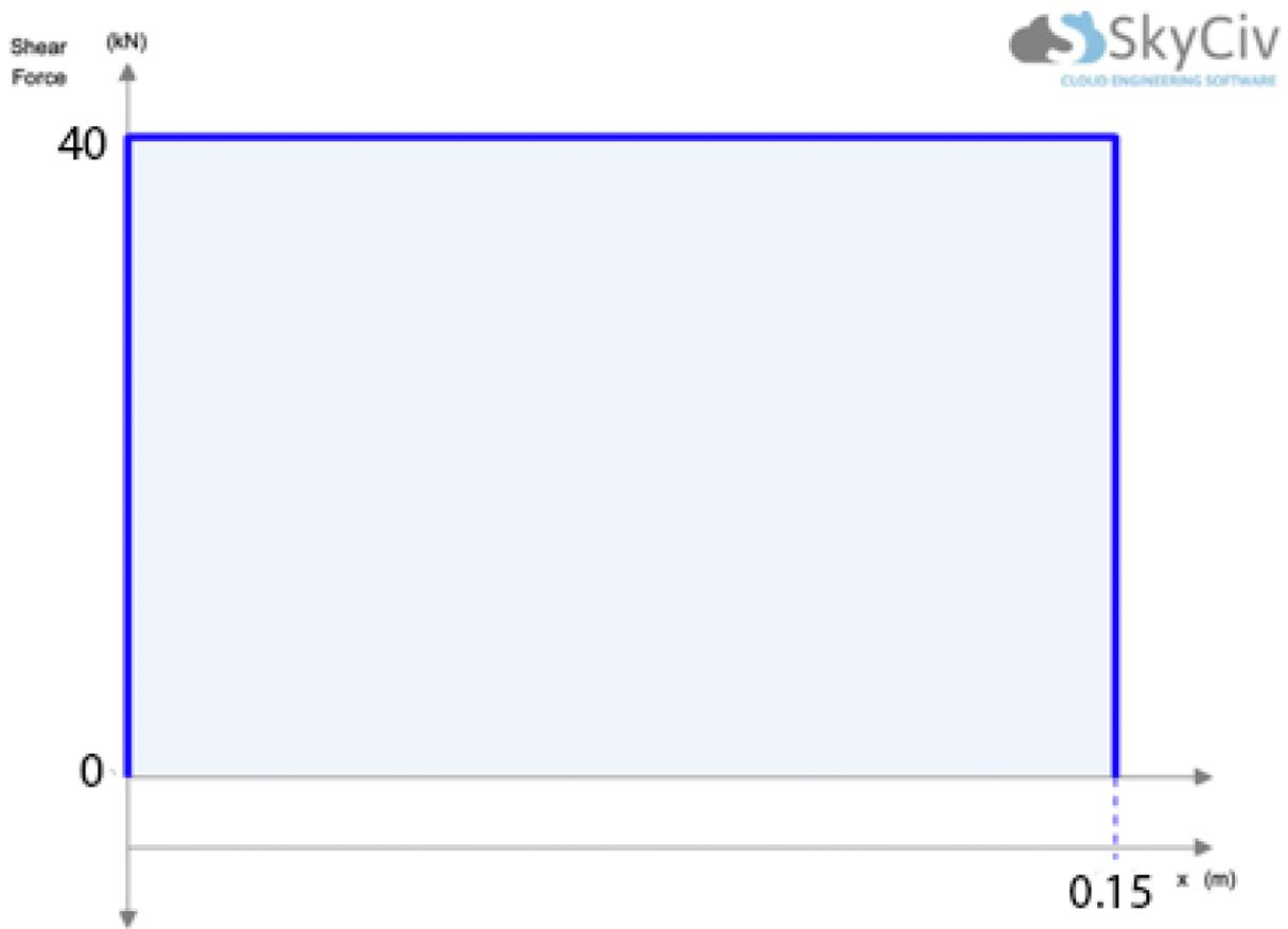
Figura 11. Cortante máximo en la barra
