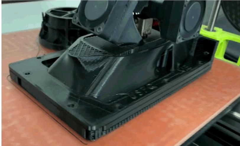
Figura 17. Impresión 3D - Cuerpo del propulsor
