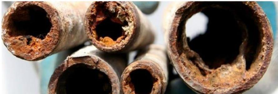
Figura 1. Corrosión de tuberías. (Scalebuster, s.f).
