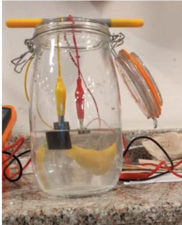
Figura 16. Celda Galvánica con agua salina
