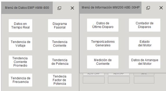
Fig. 28. Menús para cada tipo de sensor que corresponde a un módulo del MCC
