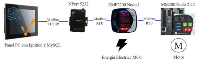
Fig. 11. Topología general del HMI y dispositivos
