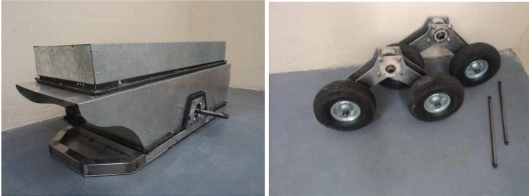
**FIGURA 7.1-3: Plataforma descompuesta en módulo central y módulos de transmisión**
