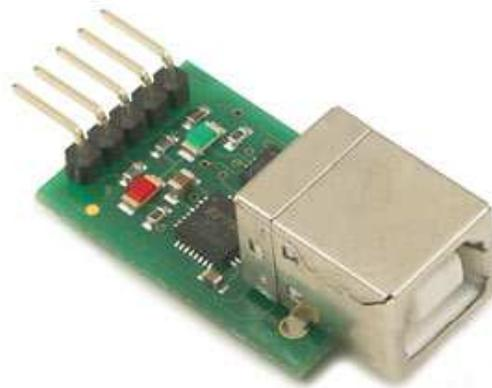
**FIGURA 4.3.4-2: Adaptador USB-I2C “Devantech USB-I2C module”**
