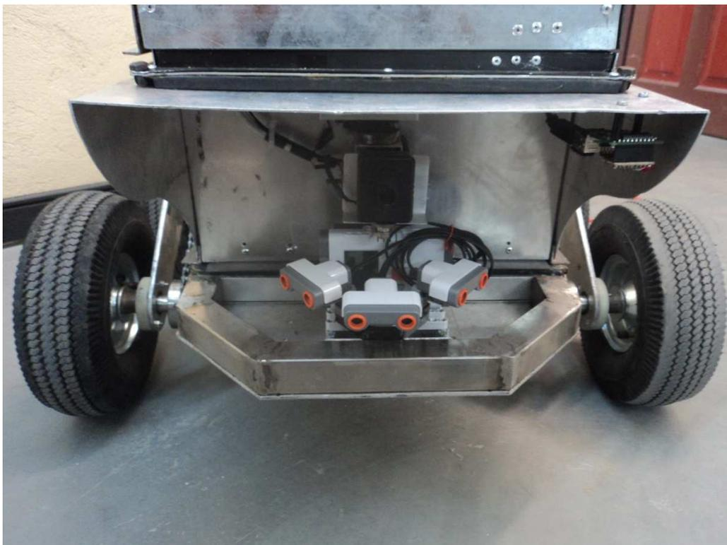
**FIGURA 5.2.3-2: Sensor de ultrasonido y base con motor**
