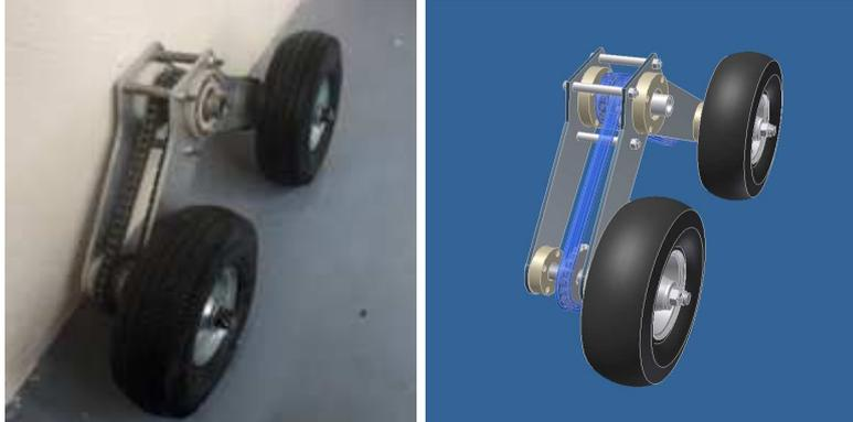
**FIGURA 5.6-9: Módulo de transmisión construido**
