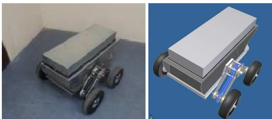
**FIGURA 5.6-13: Vehículo autónomo ensamblado – tapa de componentes electrónicos cerrada**
