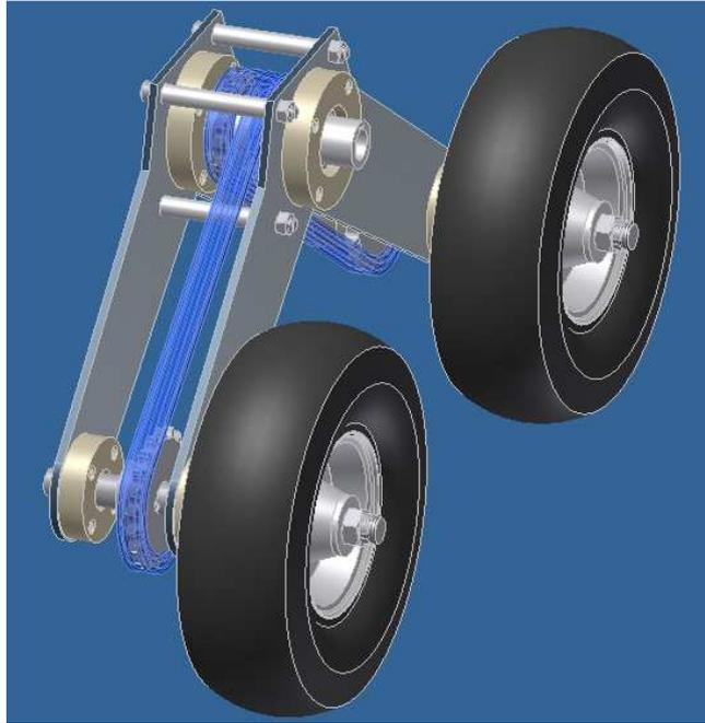
**FIGURA 5.3-11: Módulo de transmisión**
