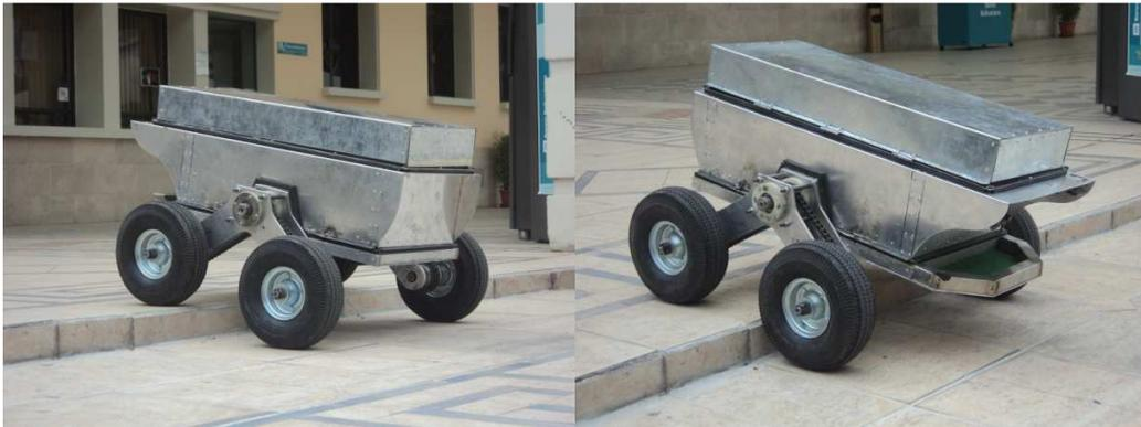
**FIGURA 7.1-1: Prueba que consiste en subir y bajar un escalón en modo RC**
