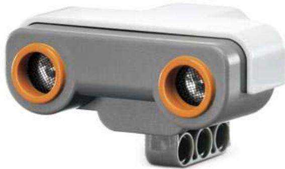
**FIGURA 4.3.5-2: Sensor de ultrasonido LEGO**
