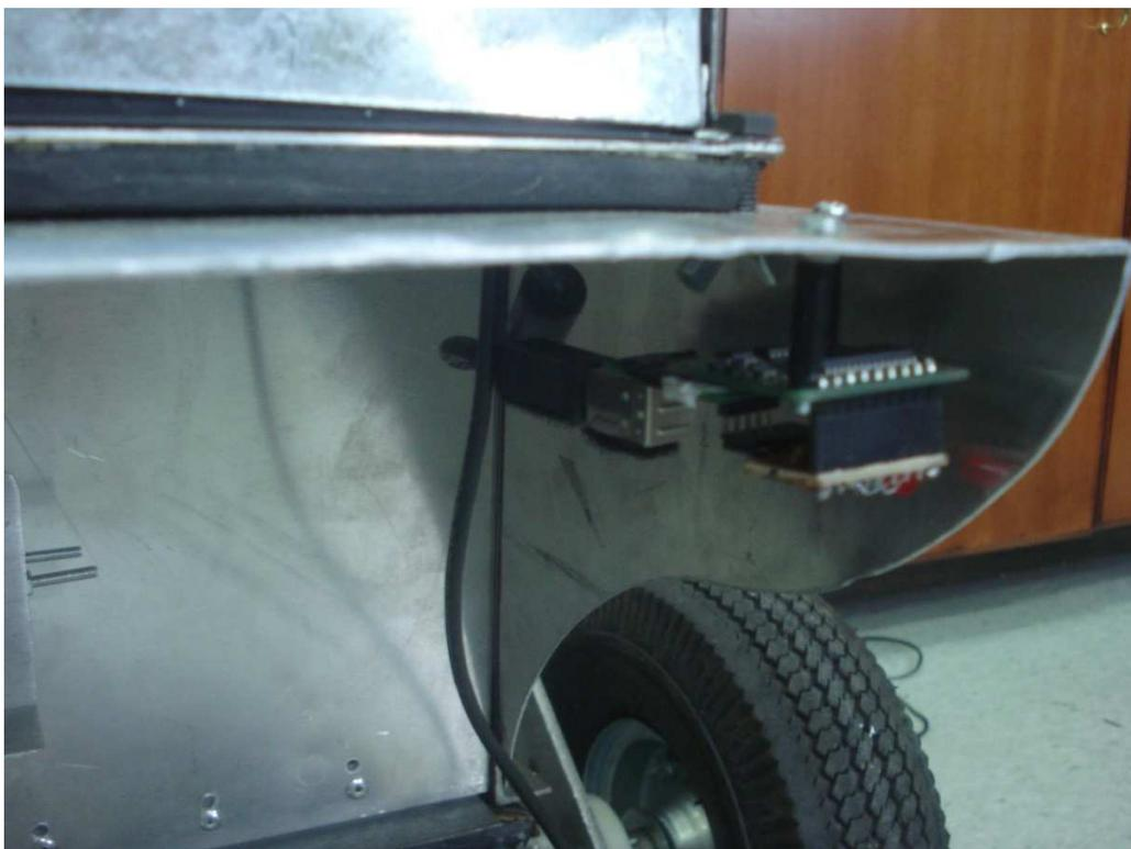
**FIGURA 5.1.2-13: Sujeción de la brújula electrónica**
