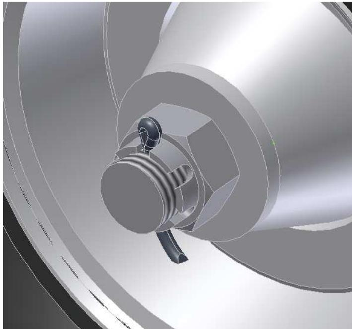
**FIGURA 5.3-8: Sistema de fijación de las ruedas a los ejes**
