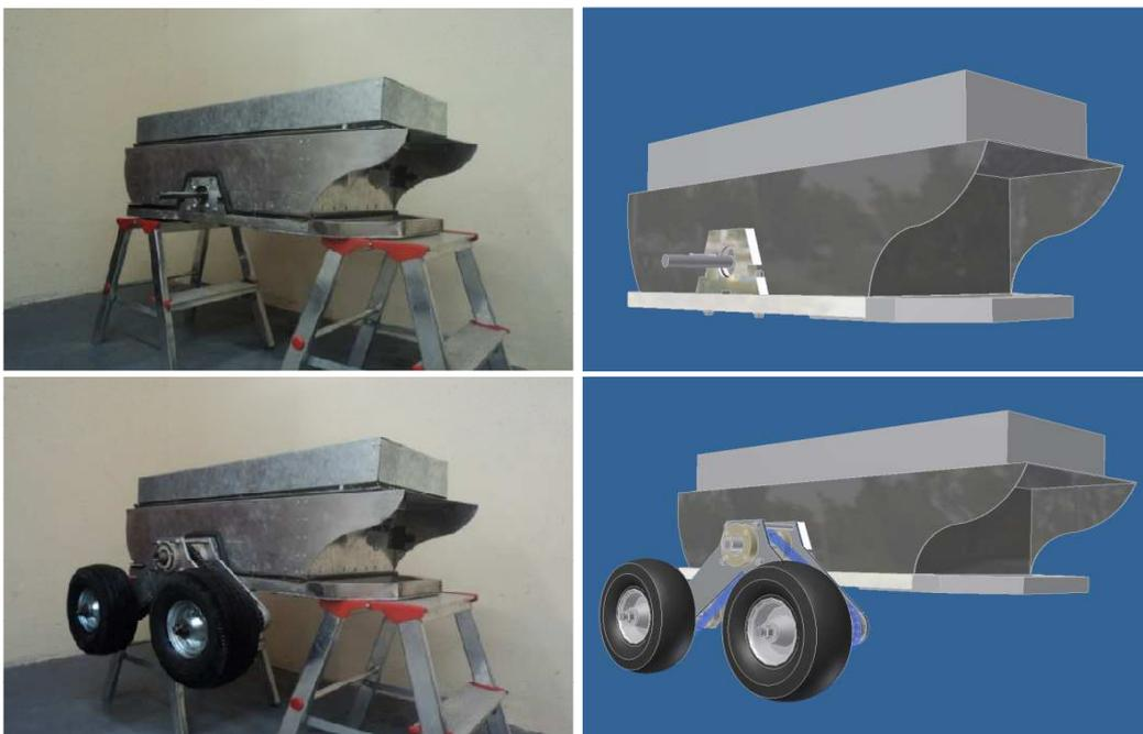
**FIGURA 5.6-10: Ensamblaje de módulo central y módulos de transmisión**
