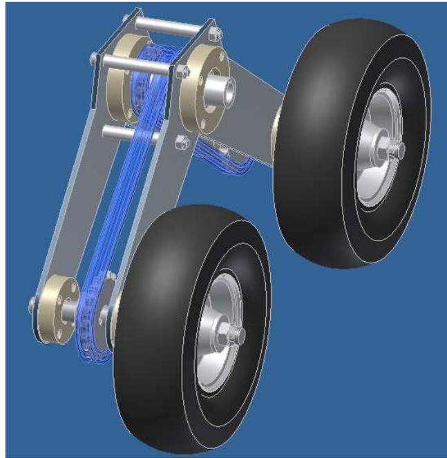
**FIGURA 5.3-1: Módulo de transmisión**
