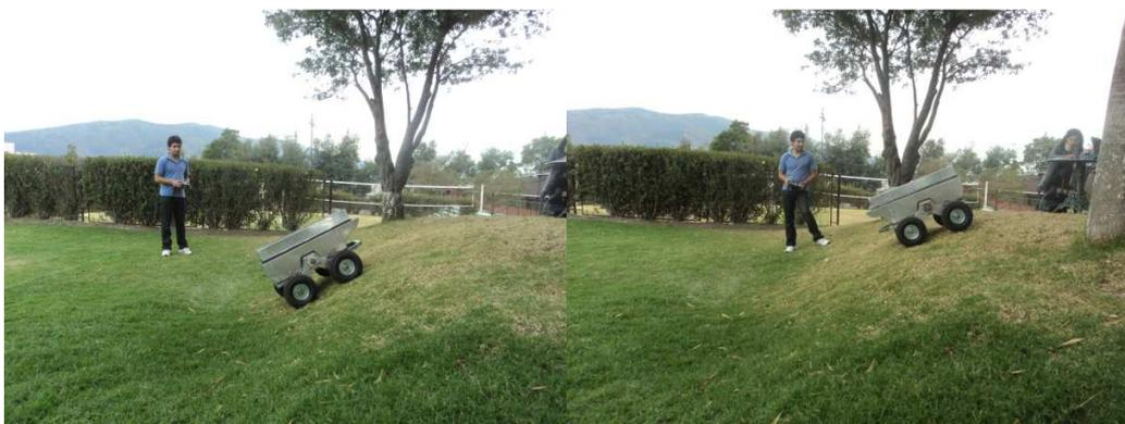
**FIGURA 7.1-2: Prueba que consiste en subir y bajar una pendiente de inclinación mayor a 20°**
