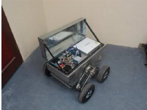
**FIGURA 5.6-14: Vehículo autónomo ensamblado – tapa de componentes electrónicos abierta**
