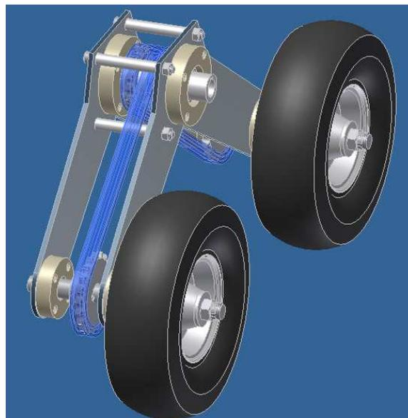
**FIGURA 5.6-6: Módulo de transmisión ensamblado**
