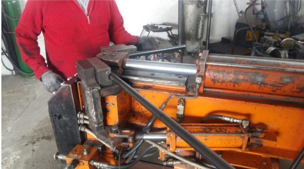
**Figura 47 Doblado de tubo para obtención de la U de la Junta Universal**
