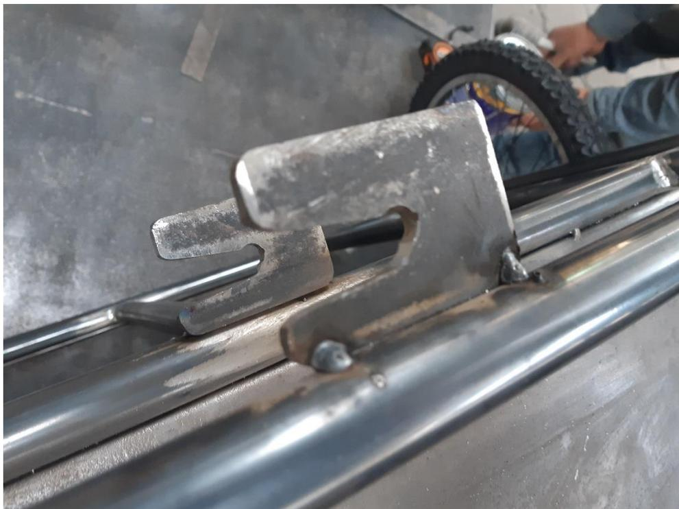
**Figura 46 Platinas de soporte eje trasero remolque soldadas al chasis**
