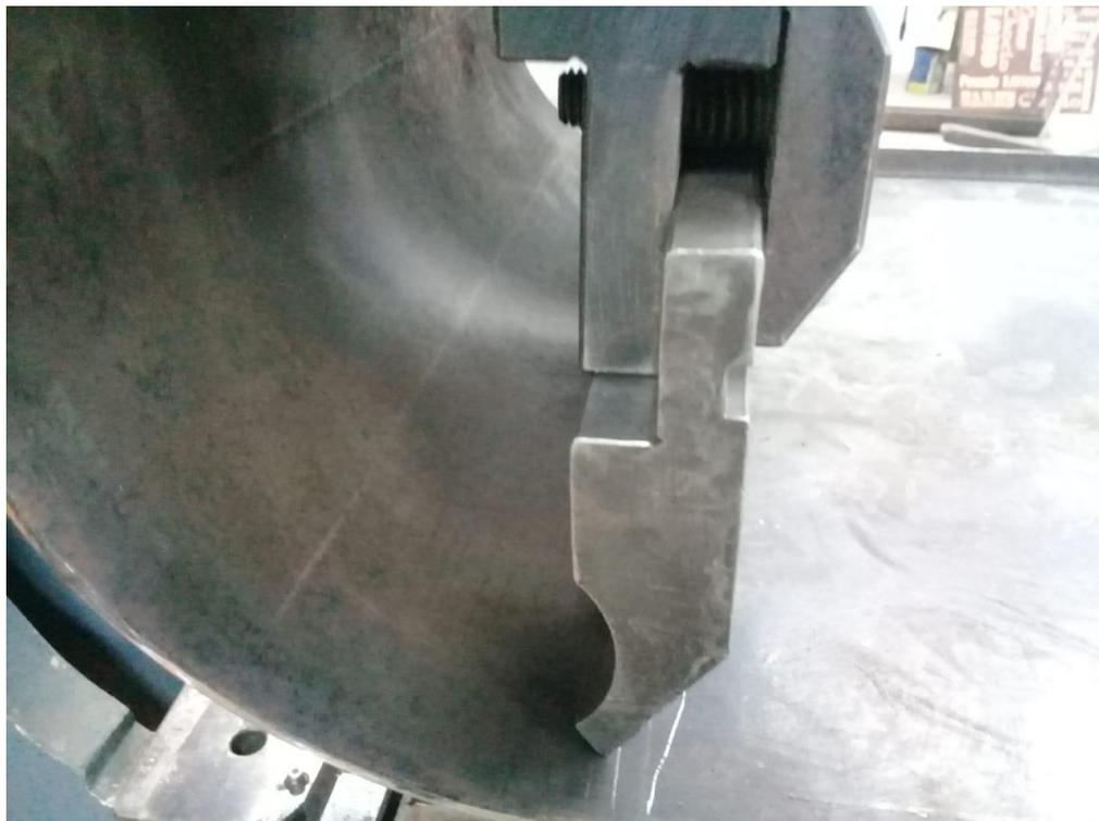
**Figura 49 Doblado lineal de plancha acero ASTM A36 espesor 2 mm**
