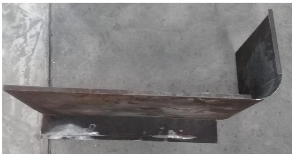
**Figura 50 Resultado final doblado de plancha metálica para carcasa**
