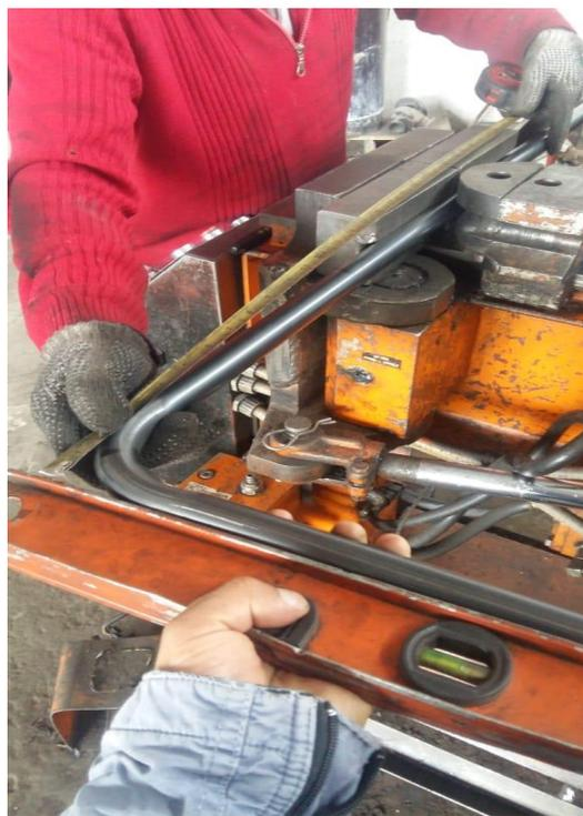
**Figura 42 Doblado perpendicular de tubo**
