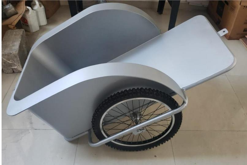
**Figura 54 Prototipo Remolque terminado**
