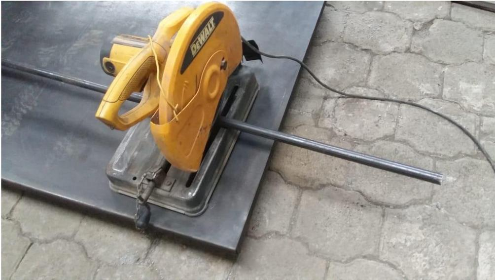
**Figura 40 Corte tubo de 1 pulgada y espesor de 2mm con ingleteadora**
