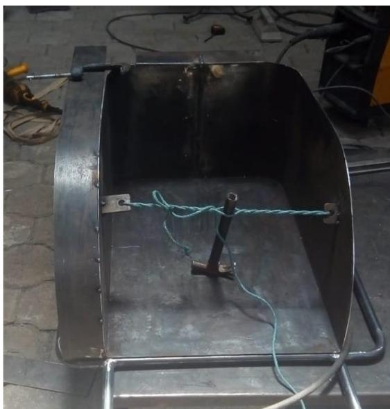
**Figura 52 Doblado de Aletas laterales que cubren la llanta**
