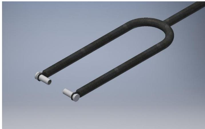
**Figura 28 Perno de acople a eje trasero bicicleta**
