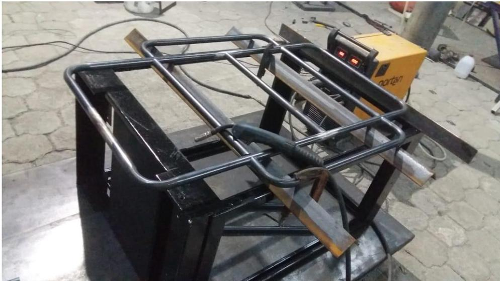
**Figura 44 Chasis Soldado por medio de soldadura FCAW**
