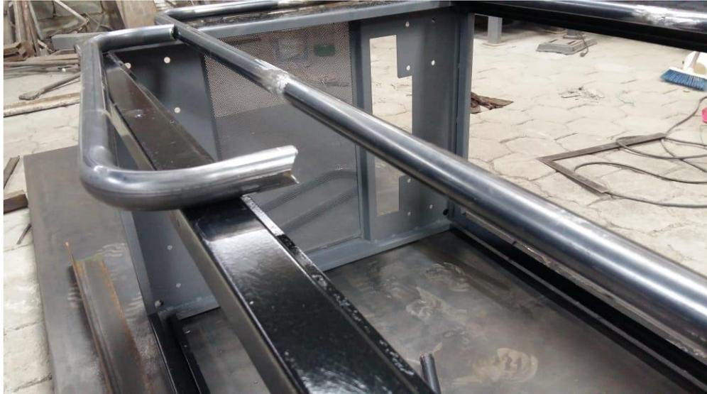
**Figura 43 Segmentos tubulares del chasis para ser soldados**
