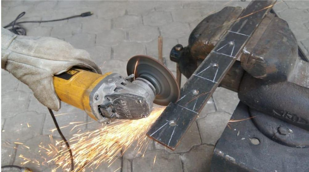
**Figura 45 Corte Platina para soporte de eje de llantas traseras del remolque**
