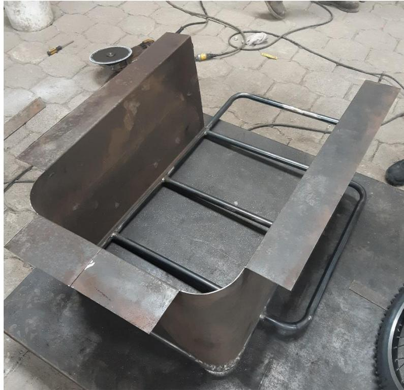
**Figura 53 Carcasa montada en el chasis**
