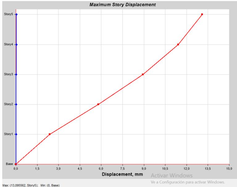
Figura # 48: Desplazamiento máximo de la estructura en sentido Y
