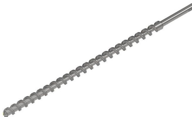
Figura 6 Vista isométrica de tornillo extrusor.
