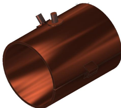
Figura 8 Vista isométrica de resistencias tipo abrazadera.
