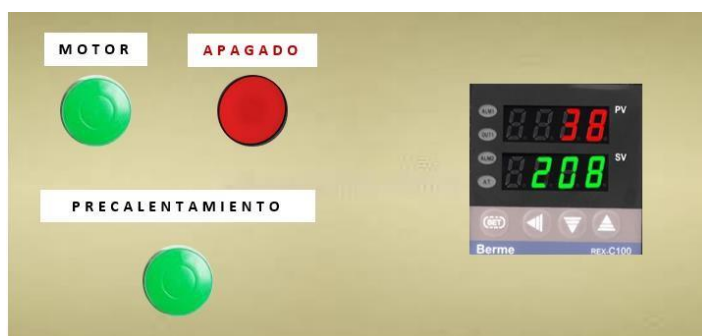
Figura 39 Tablero eléctrico de extrusora.
