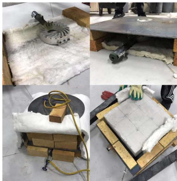
Figura 8: Armado de horno no industrial para exposición a altas temperaturas (Moreno, 2018)
