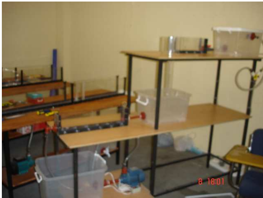
Figura 1: Modelo hidráulico del vertedero a vórtice
