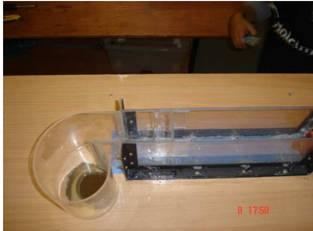
Figura 4: Vertedero a vórtice
