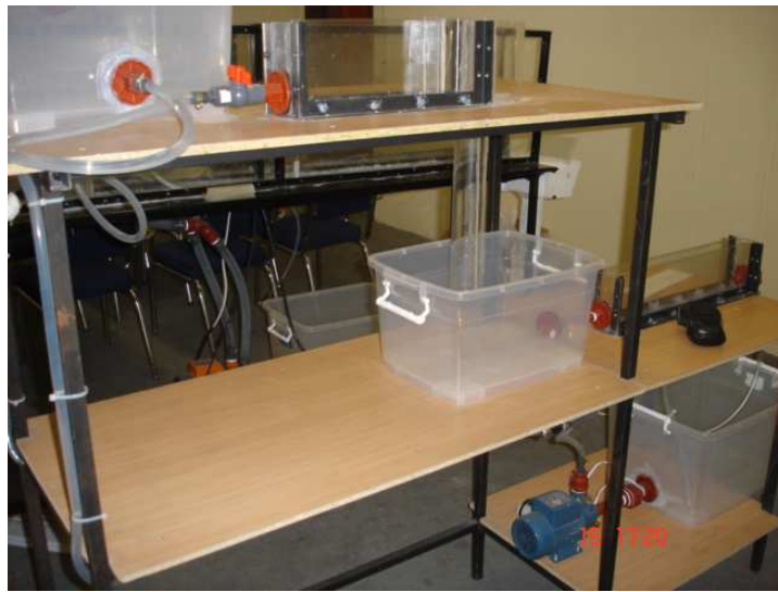
Figura 3: Canal de Entrada, tubo vertical y tanque de llegada
