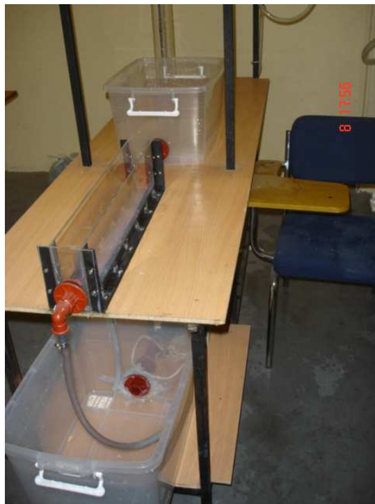
Figura 2: Canal de conducción y tanque de reserva de la bomba
