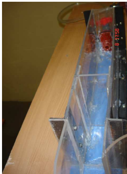
Figura 7: Cámara de entrada y compuerta de regulación de caudales
