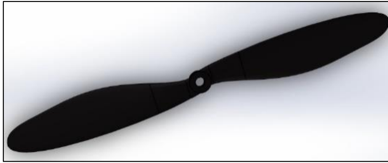
Figura 35. Modelo CAD Hélice 17x15.8 in
