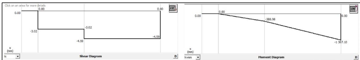
Figura 8. Diagrama de corte y de momento utilizando MDSolids 4.0 – pilar delantero
