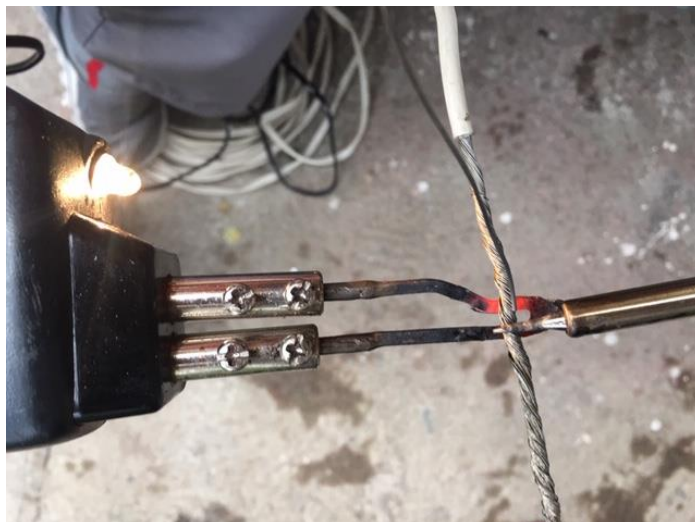
Figura 15. Proceso de estañado en cable para soldar en los terminales de la celda.
