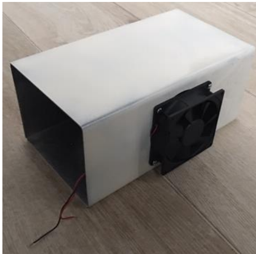
Figura 26. Caja exterior pintada y con montaje de ventilador.
