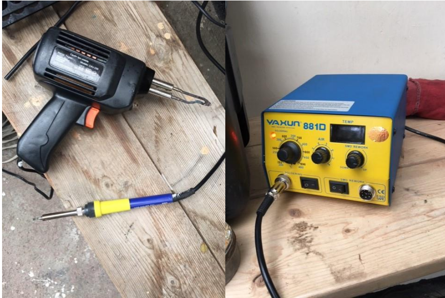
Figura 13. Cautín de soldadura tipo pistola y tipo lápiz.
