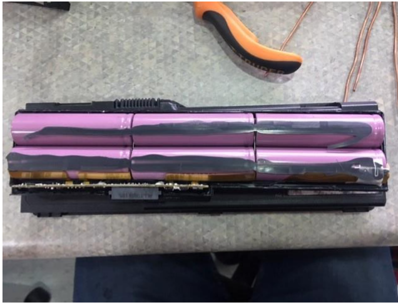
Figura 7. Celdas 18650 dentro de la batería de laptop.
