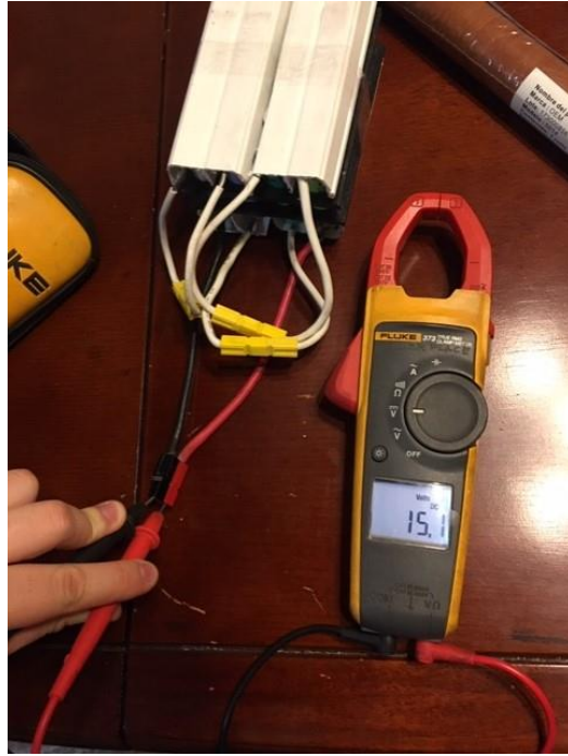
Figura 17. Medición del voltaje del paquete de baterías.
