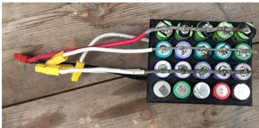
Figura 15. Proceso de estañado en cable para soldar en los terminales de la celda.
