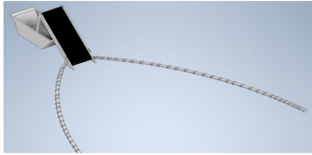
Figura 6. Sistema de retención con flotadores
