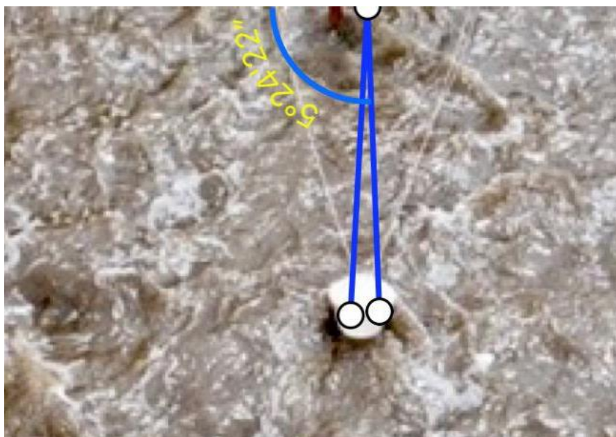
Ángulo de rotación de 5° con dos anclas
