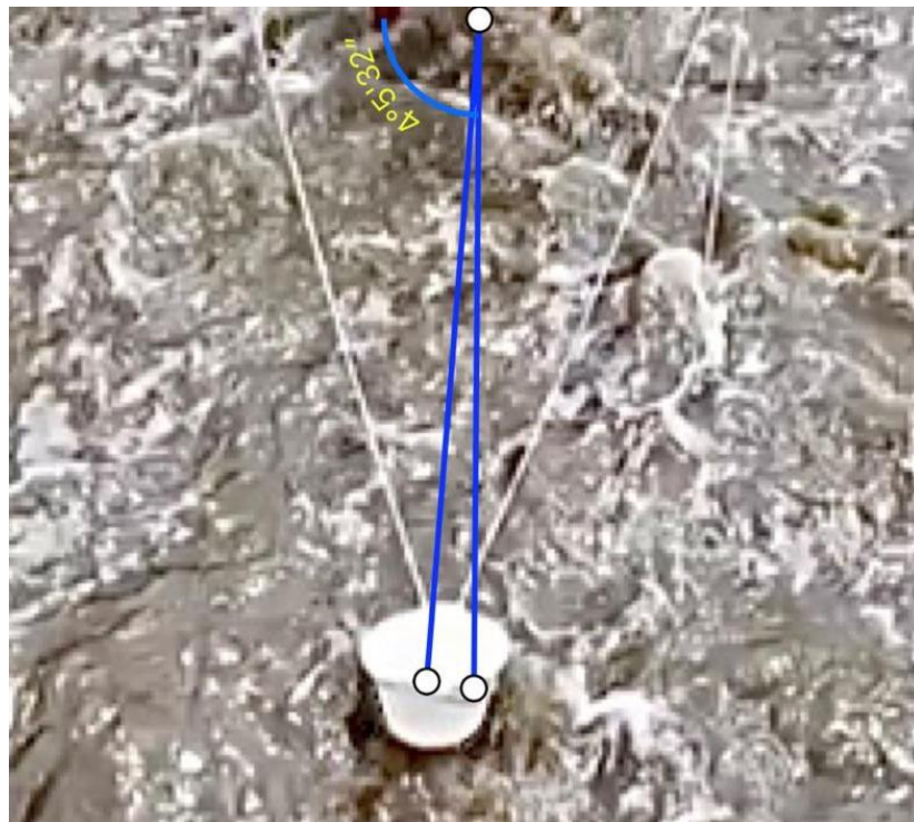
Medición de ángulo para un ancla
