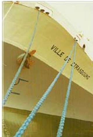
Figura 110. Cables de polipropileno (Almazán Gárate, Palomino Monzón, Paramio Cabrera, & Espinosa Goded)
