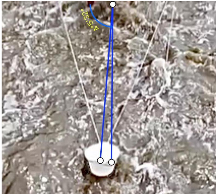
Ángulo de rotación de 4° con dos anclas
