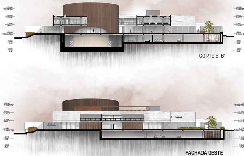
Fig. 33: Corte y fachada oeste
