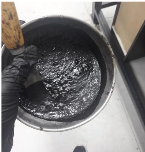
*Figura 25 Mezcla sin llegar a la rotura*
