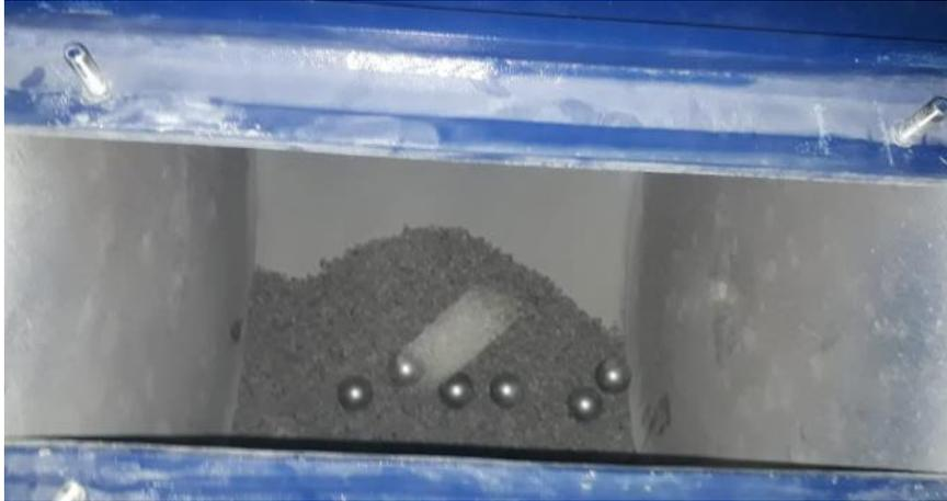
*Figura 16 Material junto a las esferas de acero*
