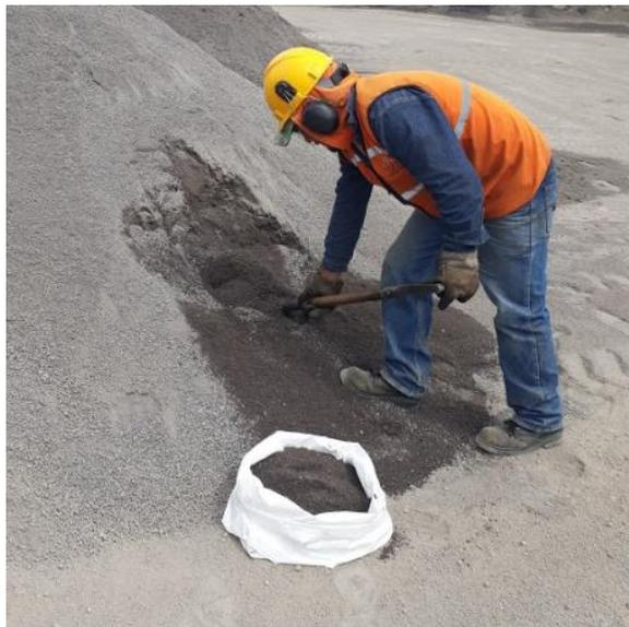
*Figura 11 Muestreo de agregados.*
