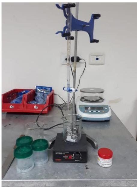
Figura 12 Materiales ensayo de Azul de Metileno.
