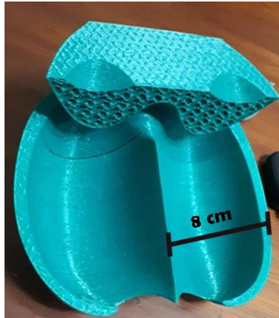
Figura 5 Impresión en 3D del álabe en escala 1:5
