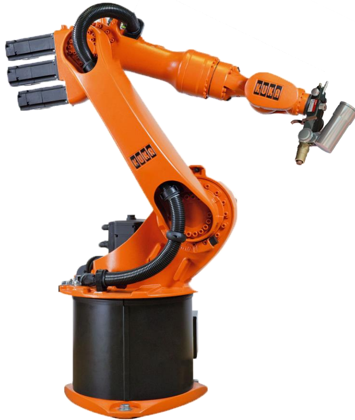
Figura 12 Torcha de termorociado Oerlikon Metco 5P-II anclada a un brazo robótico KUKA KR20
