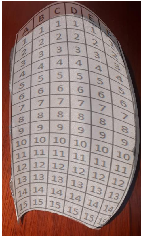
Figura 21 Sectores donde se realizaron las mediciones de espesor del recubrimiento (A y B).
