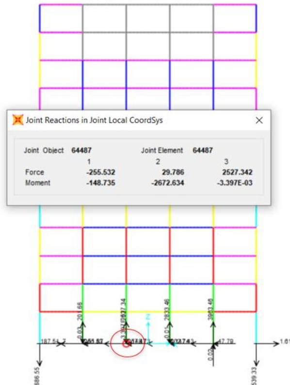
Figura 25. Reacciones en el nodo interno del marco o pórtico resistente a momento.
