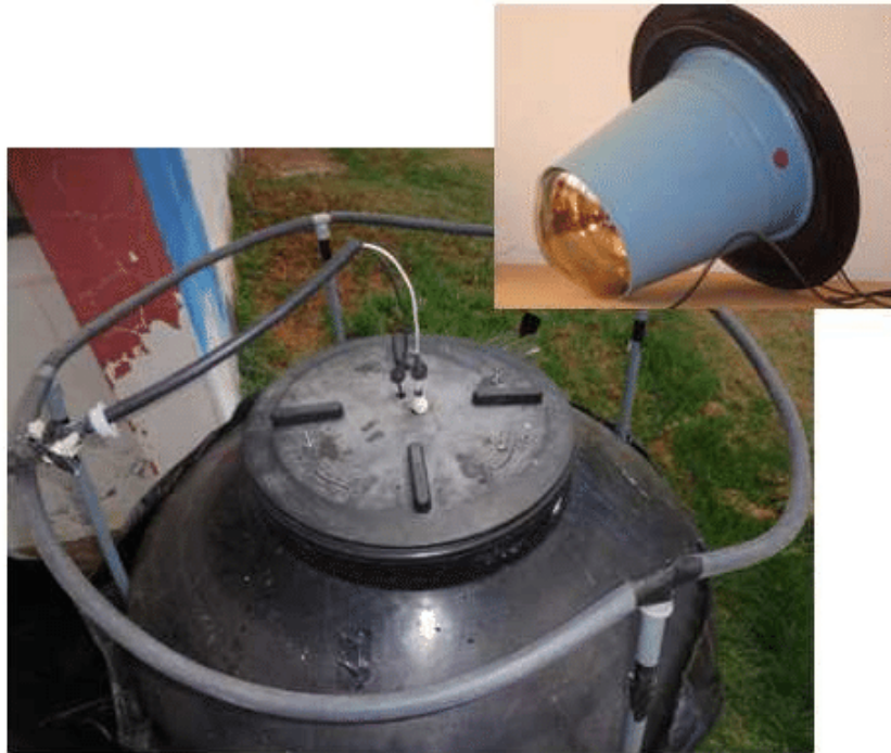
Figura 2.2: WCD instalado en Riobamba, Ecuador (2784 m.s.n.m.). Se muestra el tanque además de el tubo foto-multiplicador y su soporte
