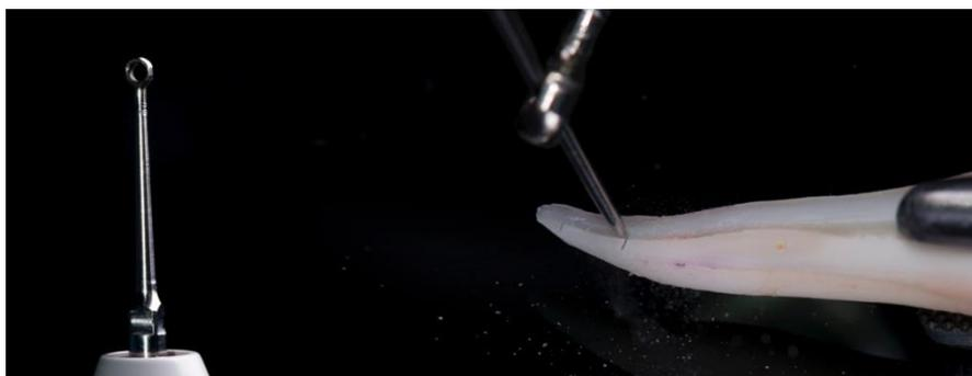
**Figura 12. Creación de la grieta estandarizada con explorador DG16 y anillo HBW cerrado**
