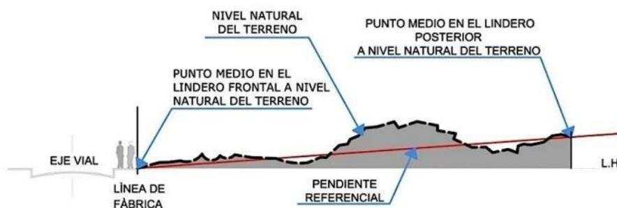
Ilustración 5-3 Vista en elevación para la definición de la pendiente referencial en terrenos irregulares que no tienen fondo
