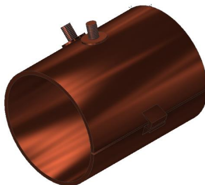
Figura 8 Vista isométrica de resistencias tipo abrazadera.
