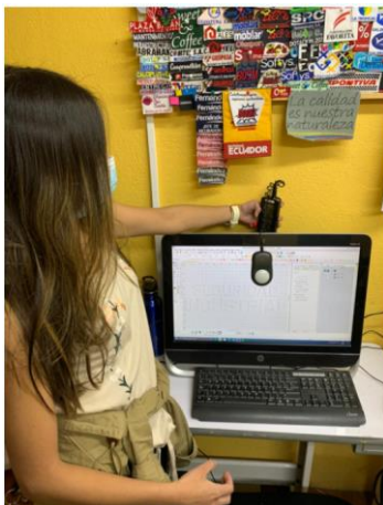
Figura 14. Medición de iluminación en el área de bordado y estampado
