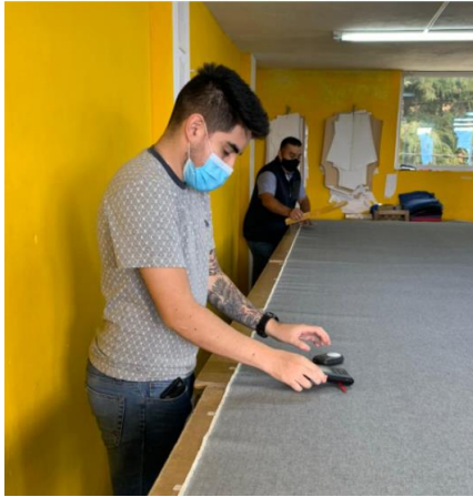
Figura 21. Medición de iluminación en el área de corte
