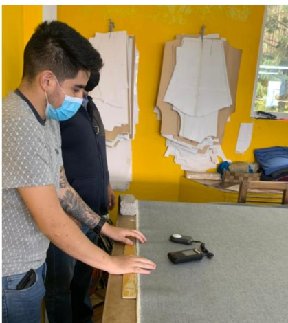
Figura 20. Medición de iluminación en el área de corte
