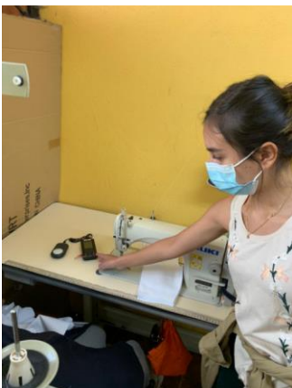
Figura 11. Medición de la iluminación área de producción
