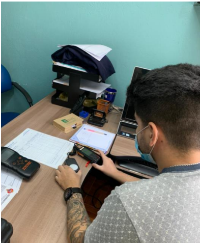
Figura 16. Medición de iluminación en el área administrativa
