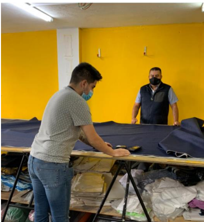
Figura 19. Medición de iluminación en el área de corte
