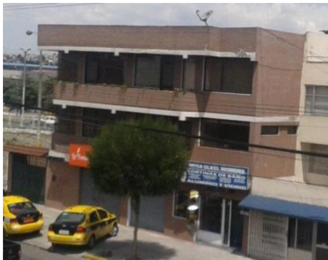
Figura 7: Fotografía de una vivienda residencial con tipología estructural de hormigón armado hecho en sitio pórticos rellenos, dúctil (Ayala, Sosa, & Chicaiza, 2017)
