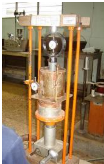
Figura 2: Ensayo de CBR en laboratorio (Yáñez, 2021)
