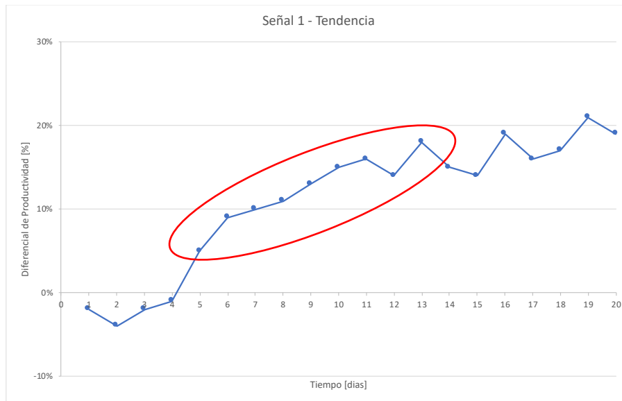
Figura 4: Señal de control 1, Tendencia de los diferenciales de productividad \Delta P .
