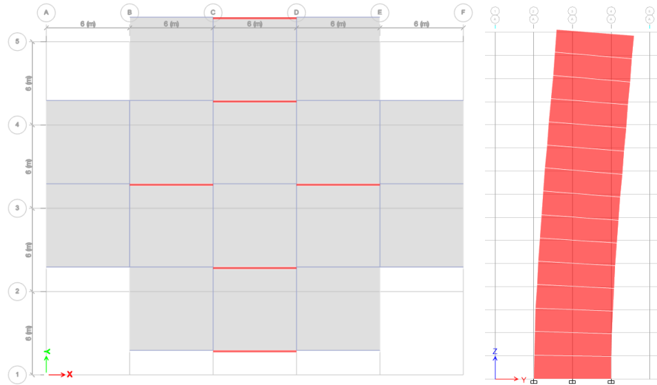
Ilustración 16: Segundo modo de vibración del sistema de muros. Elaborado por: Cristhian Alexander Cáceres Gaibor, 2021.
