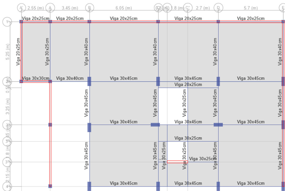
Figura 52 Vista en planta Nv+0.72m
