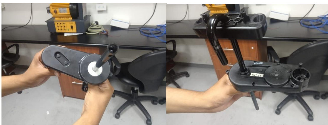
Ilustración 9 Eje de dirección del cual se reemplazó el motor
