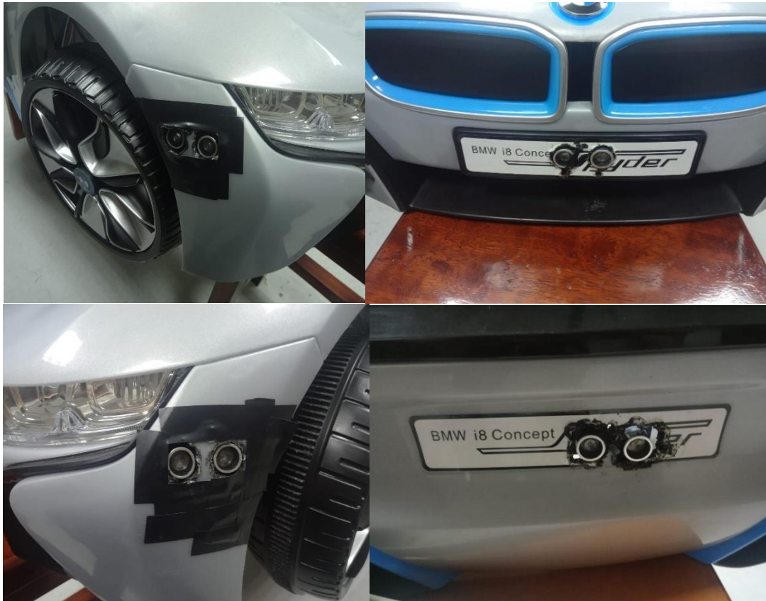
Ilustración 10 Sensores de proximidad instalados en el chasis del vehículo
