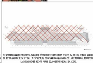
EL SISTEMA CONSTRUCTIVO ESTA DADO POR PÓRTICOS ESTRUCTURALES DE 0.80 CM, EN UNA RETÍCULA HECHA EN 45° GRADOS DE 7.2M X 7.2M. LA ESTRUCTURA ES DE HORMIGÓN ARMADO DE LA EX TERMINAL TERRESTRE. LAS ANIDACIONES HECHAS POR EL EQUIPO ESTÁN HECHAS EN AZERIO.
