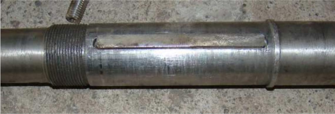
Ilustración 44: Rosca, Chavetero y Chaveta del Eje
