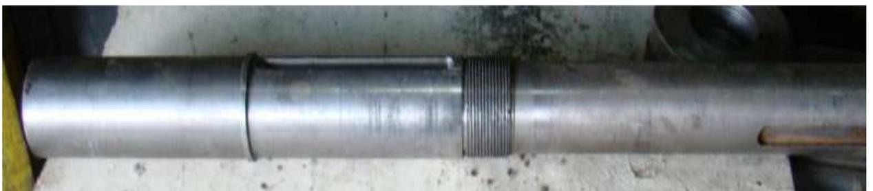
Ilustración 43: Eje Maquinado
