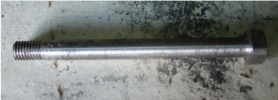
Ilustración 42: Perno porta Martillos Maquinado
