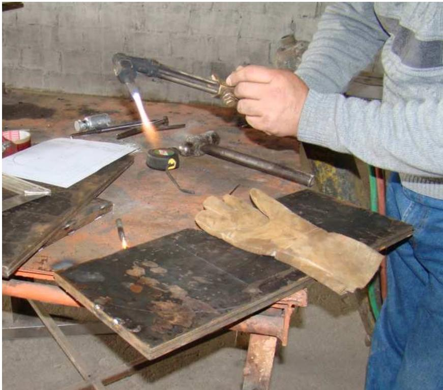
Ilustración 50: Corte de las Paredes con Oxicorte
