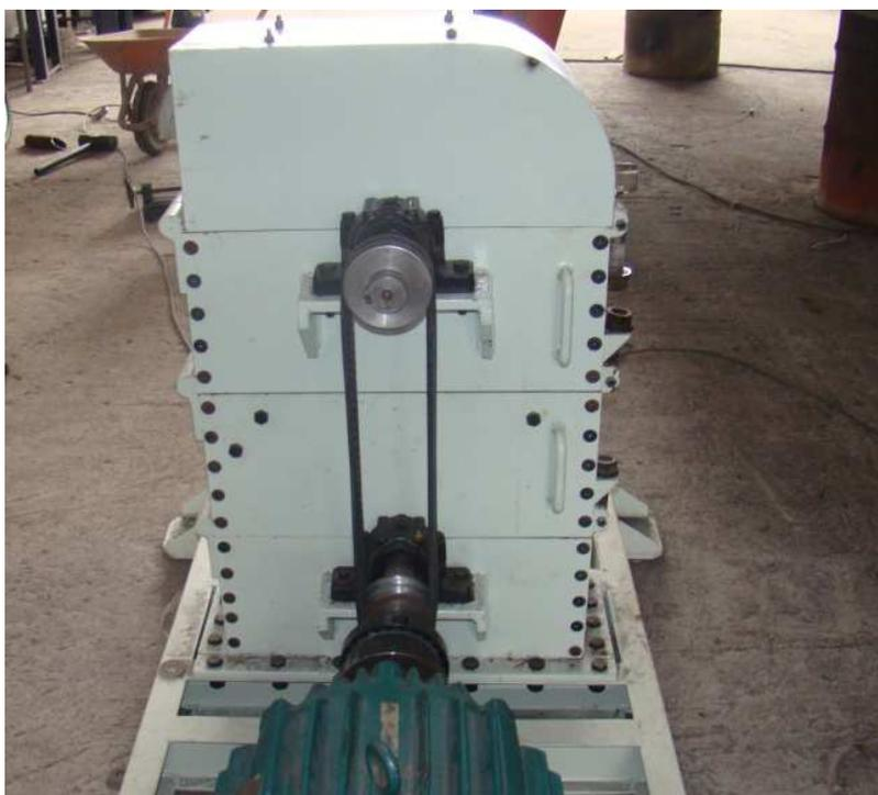
Ilustración 60: Poleas y Bandas del Molino
