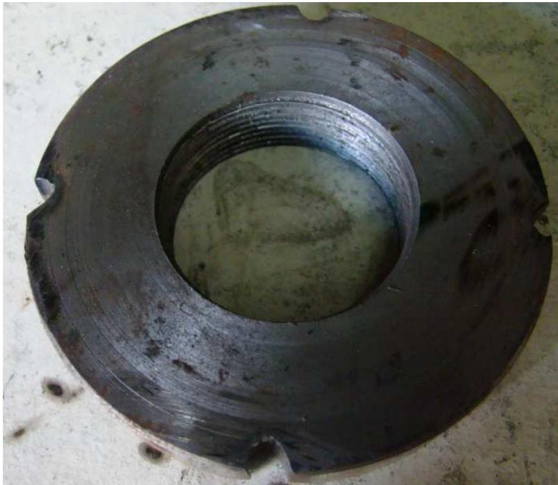
Ilustración 47: Tuerca del Eje Maquinada
