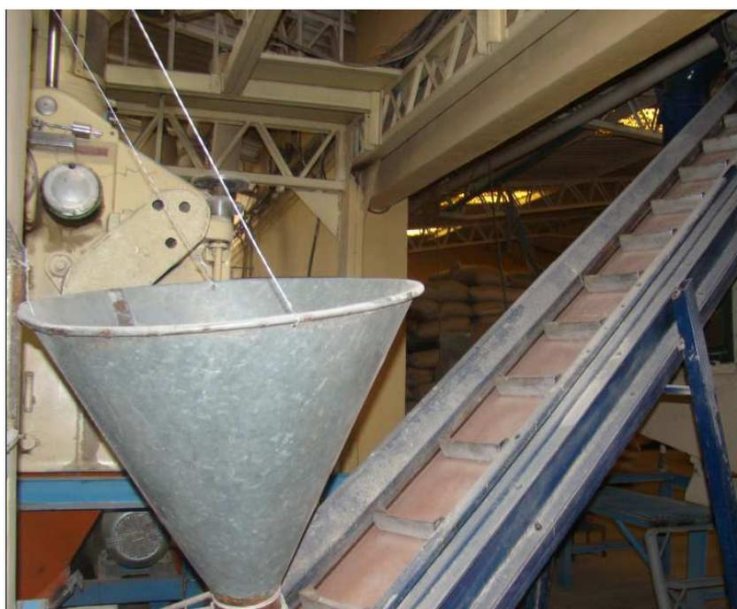
Ilustración 7: Banda Transportadora
