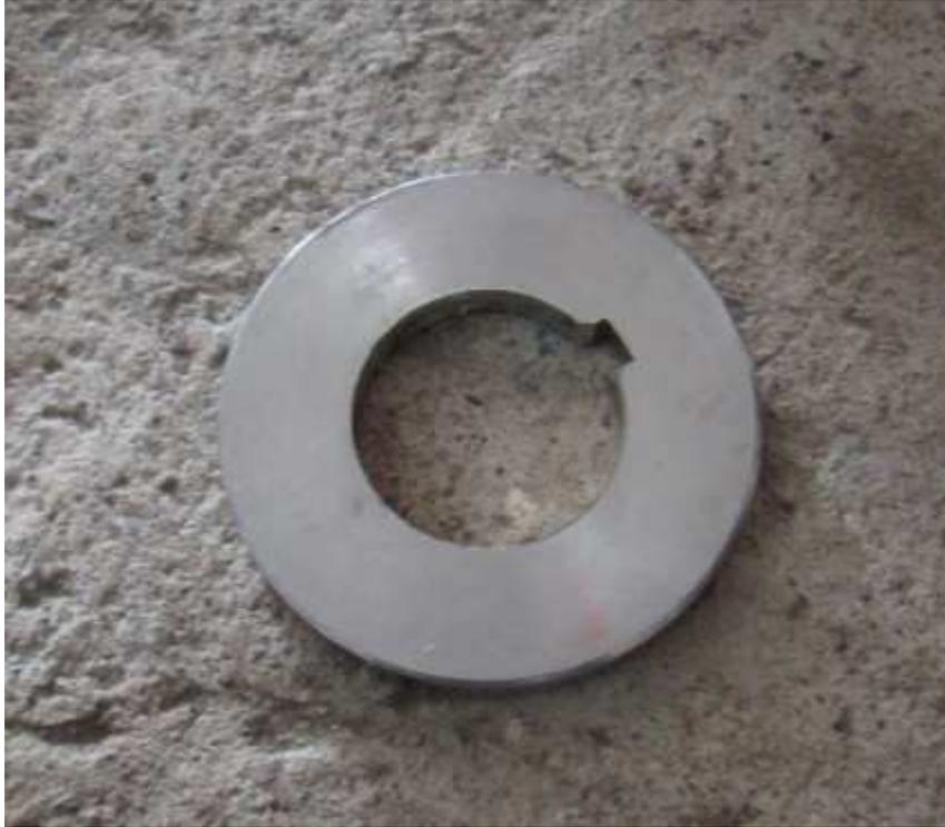
Ilustración 46: Separador de Discos Maquinado
