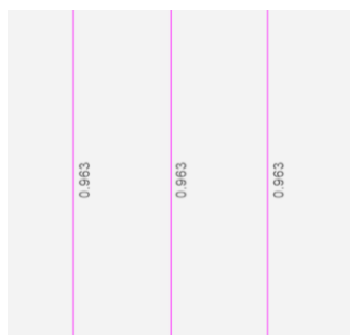
Figura 39: Demanda/Capacidad para vigas secundarias en ETABS
