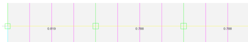
Figura 40: Demanda/Capacidad para vigas principales en ETABS
